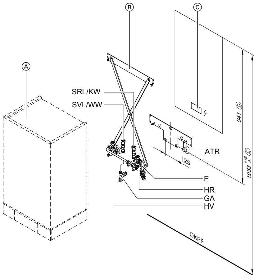
Изображено: подключение газового водогрейного котла
