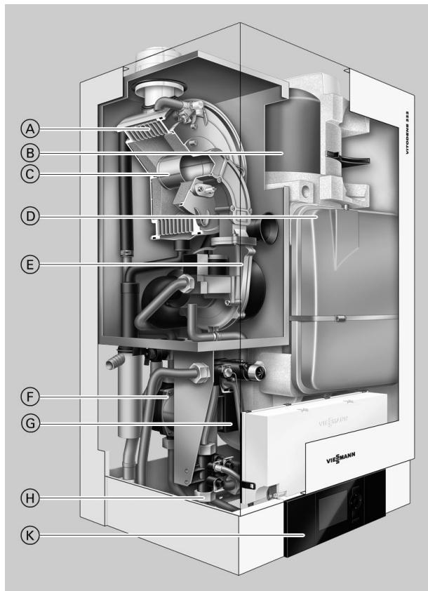
Котел Vitodens 222-W представляет собой особо компактный газовый конденсационный котел настенного типа для высоких требований комфорта по горячей воде. Котел состоит из теплообменника Inox-Radial из высококачественной стали, модулируемой цилиндрической горелки Matrix и автоматического регулятора сгорания Lambda Pro Control.
