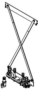
Монтажное приспособление для скрытой проводки
