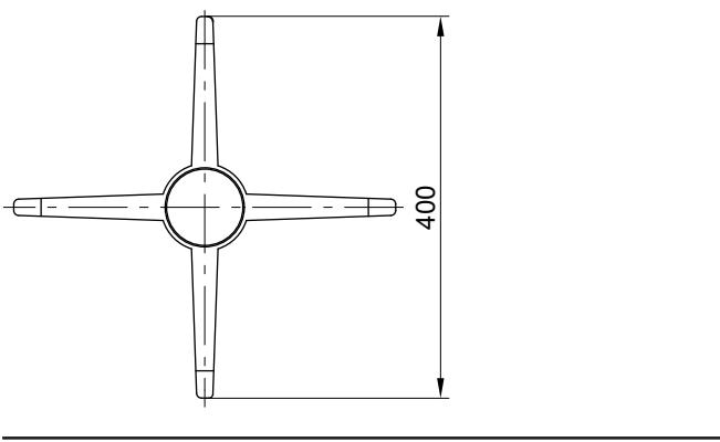
Комплект поставки 3 шт. (используется для внутреннего размера шахты 130 × 130 мм - 250 × 250 мм или Ø 150 мм - Ø 300 мм). Макс. расстояние 5 м.
