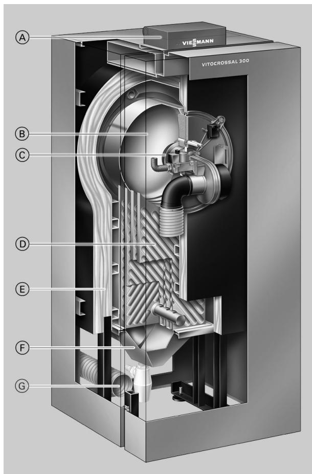
Котел Vitocrossal 300 представляет собой напольный газовый конденсационный котел самого высокого класса. Благодаря своей конструкции он использует теплоту конденсации собственных дымовых газов с наибольшей эффективностью. Особо следует отметить режим эксплуатации с отбором воздуха для горения извне. Благодаря этому котел Vitocrossal 300 может устанавливаться в теплоизолированной оболочке здания, что дает особые преимущества при расчете согласно Положению об экономии энергии.
