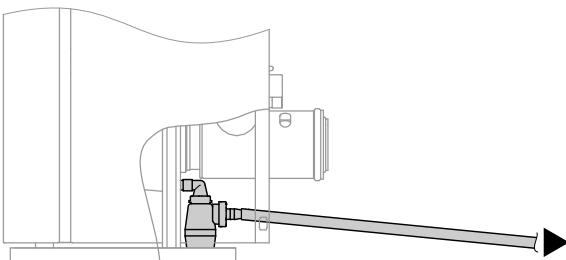
Обеспечить возможность наблюдения за отводом конденсата к канализационному сливу. Он должен быть проложен с постоянным уклоном при использовании сифонного затвора и оборудован соответствующими устройствами для отбора проб.
