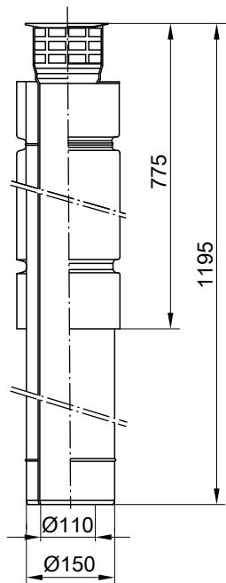
Модульный размер  $\varnothing$  100 мм
