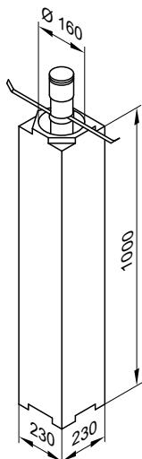
Шахту дымохода, имеющую сертификат допуска органов строительного надзора, из легкого бетона или пенокерамики можно заказать на фирме Skoberne.
