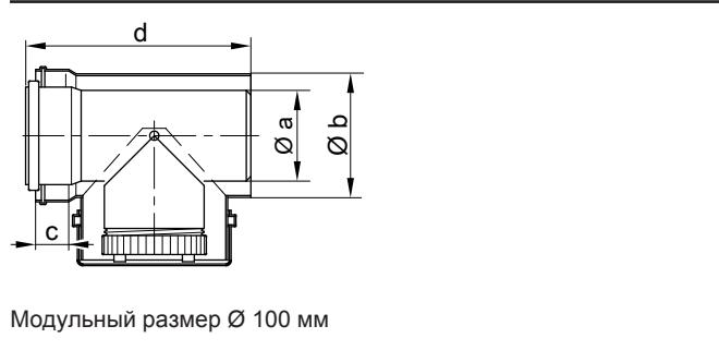
Модульный размер  $\text{Ø 100 mm}$
