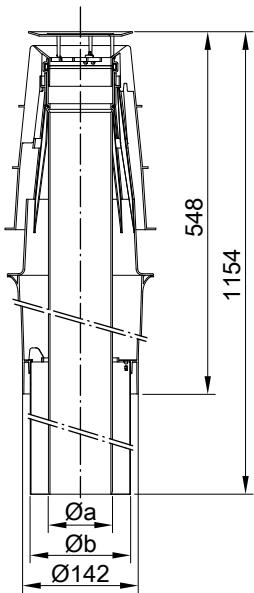
Модульный размер  $\varnothing$  80 мм
