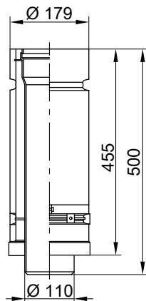
Модульный размер  $\varnothing$  100 мм
