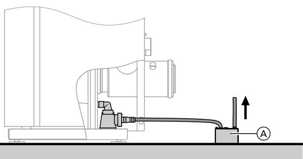
Если котел Vitocrossal 300 монтируется ниже уровня обратного подпора сточных вод, то необходима установка насоса для откачки конденсата (A) (см. принадлежности). Избегать застоя конденсата в водогрейном котле вследствие перепада высот в шлангопроводе. При установке вывинтить опоры водогрейного котла или предусмотреть платформу для котла.
