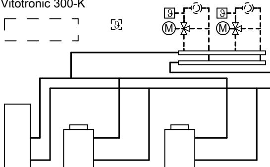
Контроллер цифрового программного управления котловым контуром:
