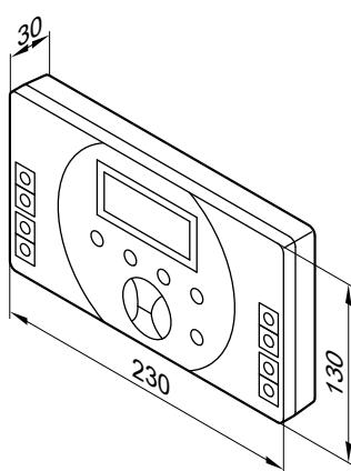
Размещение в типовом помещении на внутренней стене напротив радиаторов. Не устанавливать на полках, в нишах, а также в непосредственной близости от дверей или источников тепла (например, прямых солнечных лучей, камина, телевизора и т.п.). Датчик температуры помещения подключается к Vitotrol 300A.
