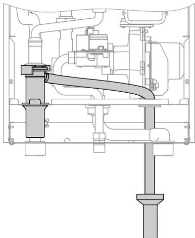
Подключить трубопровод для отвода конденсата в канализацию с созданием постоянного уклона. Трубопровод должен иметь разрыв струи.
