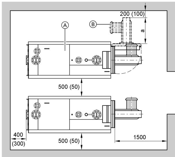
Размер а: Конструктивная длина горелки
