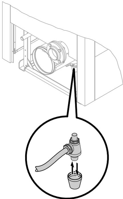
1. Отсоединить сифон и наполнить его водой (в противном случае возможна утечка продуктов сгорания).
