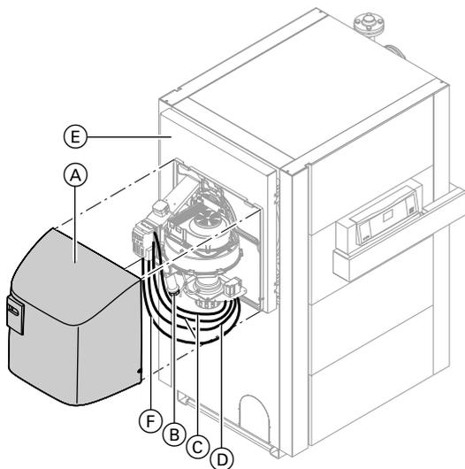
1. Снять колпак горелки (A).
