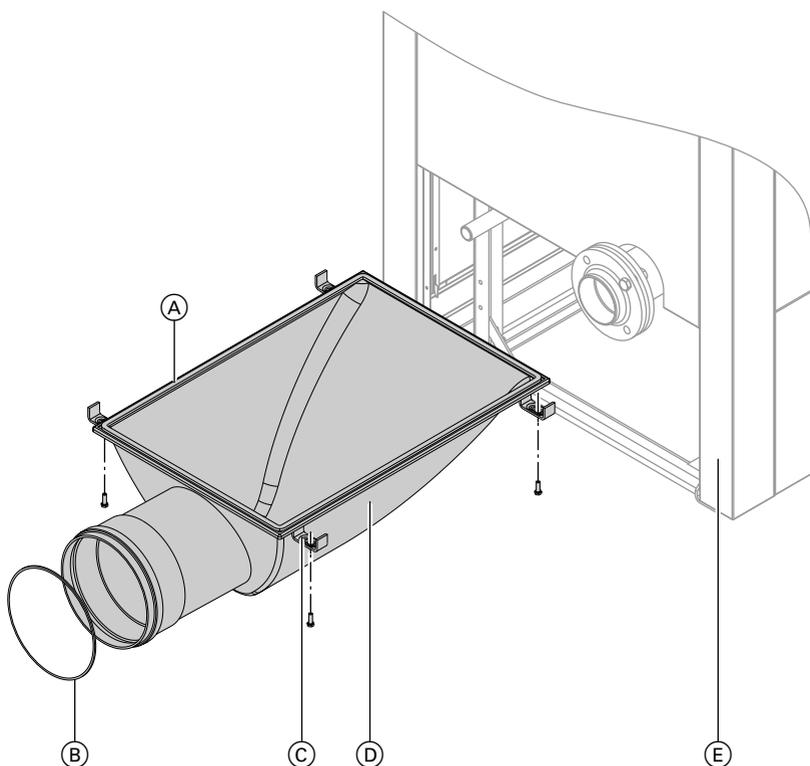
1. Проверить герметичность уплотнения **А** между коллектором уходящих газов **Д** и корпусом котла **Е**.
