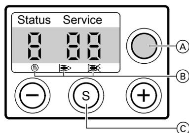
Дисплей состоит из трех 7-сегментных элементов. Четыре кнопки служат для настройки различных уровней управления.
