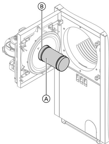
1. Проверить проволочную сетку и крышку пламенной головы (A) на предмет наличия повреждений. Небольшие волнообразные деформации пламенной головы (A) не являются неисправностью.
