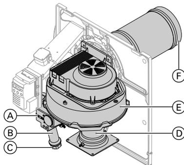
1. Развинтить резьбовое соединение **С** на трубе подключения газа **В**.
