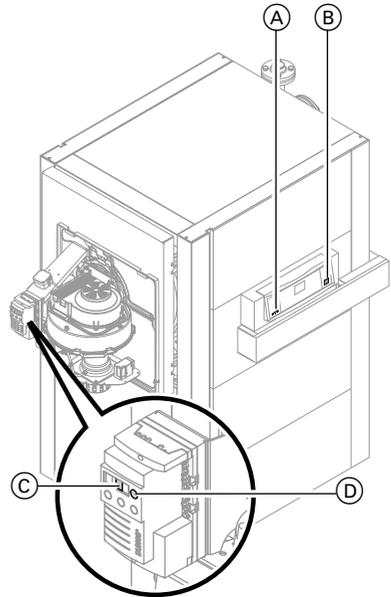
Включить выключатель установки (B) на контроллере. Если горит лампа сигнализации неисправности (A) на контроллере и мигает дисплей (C) на газовом топочном автомате, то сначала следует выполнить разблокировку; для этого нажать кнопку снятия сигнала неисправности (D) на газовом топочном автомате.
