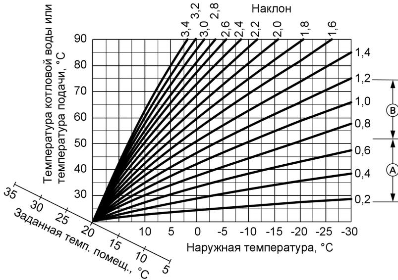
Ⓐ Наклон отопительной характеристики для внутривольного отопления
