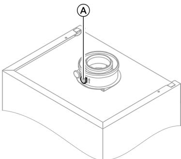
1. Подключить анализатор уходящих газов к отверстию уходящего газа (A) на присоединительном элементе котла.
