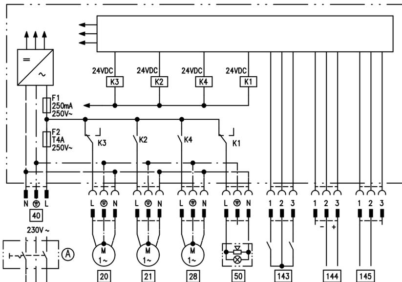
Внешний модуль расширения подключается через шину КМ к контроллеру водогрейного котла. При помощи модуля расширения можно одновременно управлять указанными далее устройствами:
