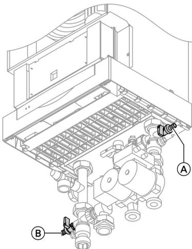
1. Закрыть запорные вентили греющего контура.
