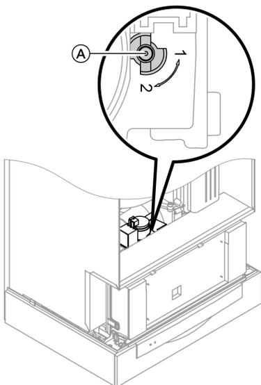
1. Установить регулировочный винт (A) на газовой регулирующей арматуре в положение "2".
