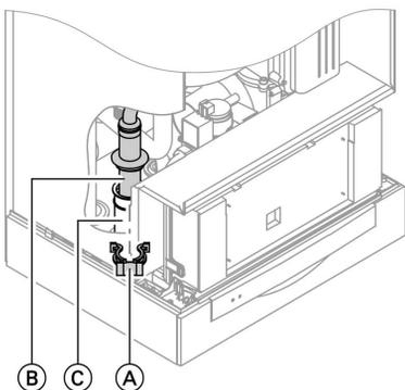
1. Снять зажимную скобу (A) и извлечь вставку (B).
