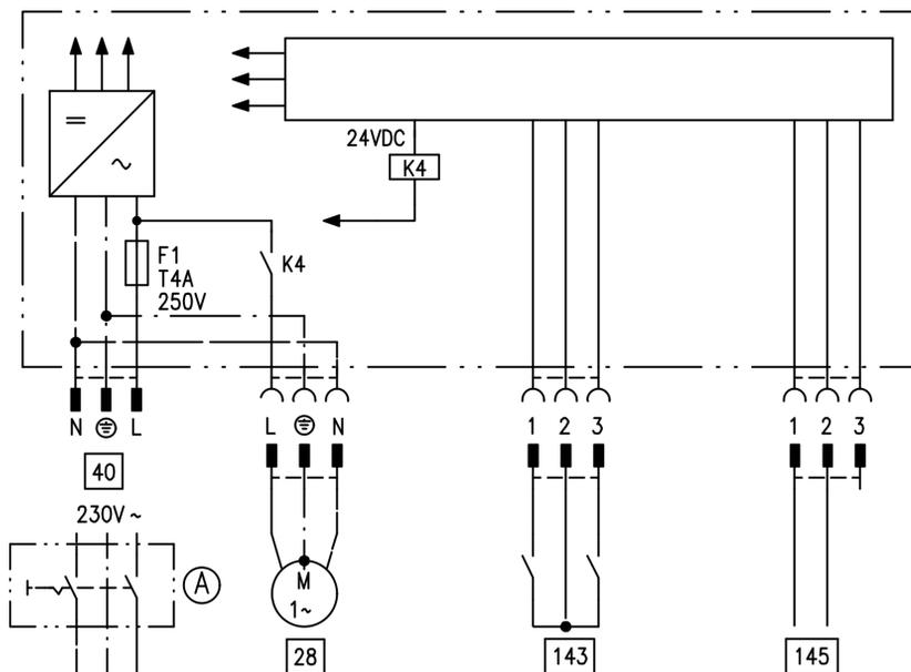
Внешний модуль расширения подключается через шину КМ к контроллеру водогрейного котла. При помощи модуля расширения можно одновременно управлять указанными далее устройствами:
