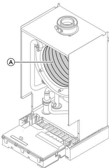
1. Отсосать накипь с теплообменных поверхностей (A) камеры сгорания.
