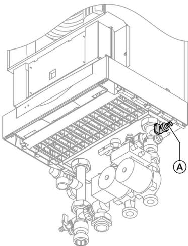
1. Проверить входное давление мембранного расширительного бака.
