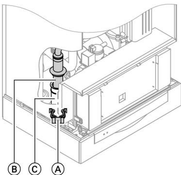
1. Снять зажимную скобу (А) и извлечь вставку (В).
