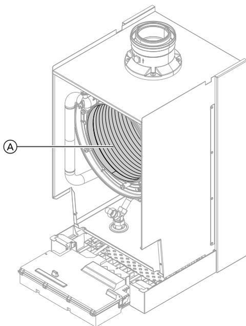
1. Удалить отложения с теплообменных поверхностей (A) камеры сгорания с помощью пылесоса.
