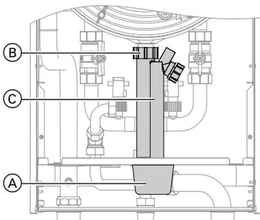
1. Снять колпачок (A), потянув его вниз.
