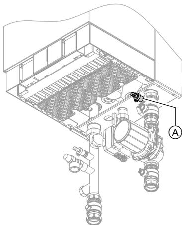
1. Проверить давление на входе мембранного расширительного бака.
