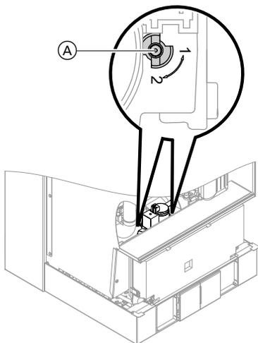
1. Установить регулировочный винт (A) на **обоих** газовых регулирующих арматурах в положение "2".
