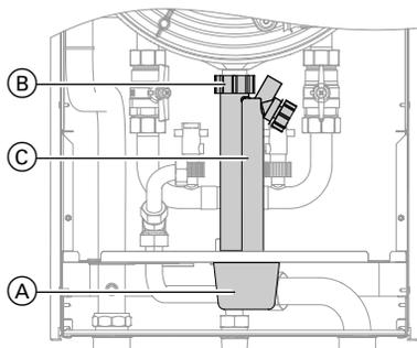
1. Снять колпачок (А), потянув его вниз.
