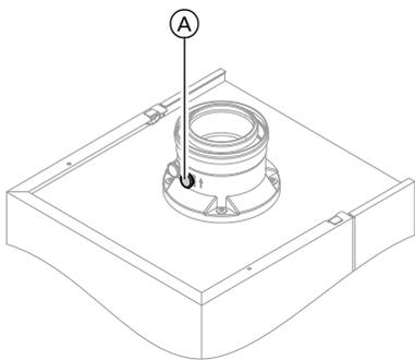
1. Подключить газоанализатор к патрубку уходящих газов (A) на присоединительном элементе котла.
