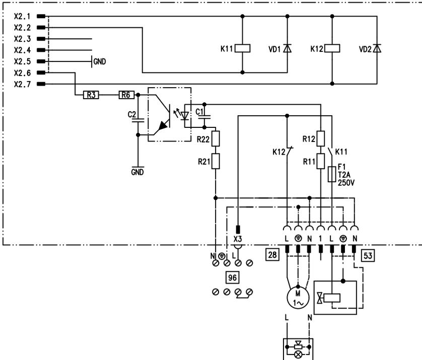
Внутренний модуль расширения монтируется в корпусе контроллера. К релейному выходу [28] могут быть подключены по выбору приведенные далее функциональные устройства. Назначение функции осуществляется кодовым адресом "53":
