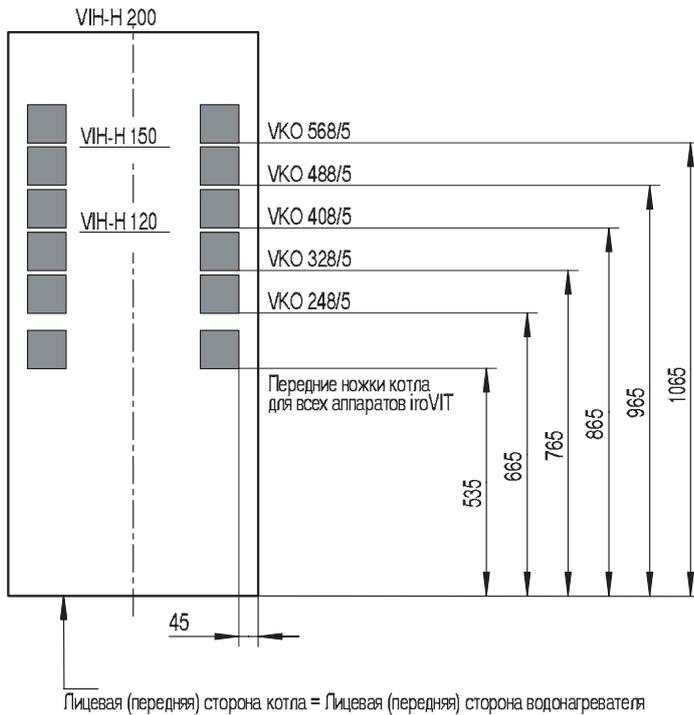
В случае установки котла iroVIT VKO или atmoVIT VK сверху на водонагреватель рекомендуется использовать в качестве подложки специальные коврики. Это позволит устойчиво расположить котёл, избавив его тем самым от возможного соскальзывания, а также предохранит поверхность корпуса водонагревателя от царапин. Расположение ковриков в зависимости от типа, марки котла и его геометрии выбирается согласно представленному на чертеже.
