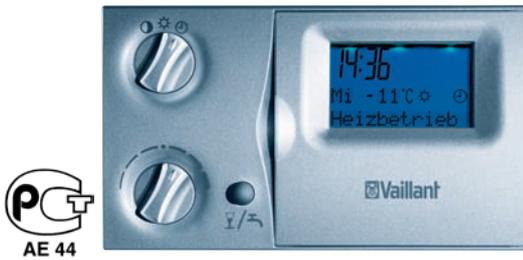
Регулятор обеспечивает регулирование температуры подающей линии отопительного контура в зависимости от погодных условий с помощью датчика наружной температуры. Кроме того, он может управлять приготовлением горячей воды и циркуляционным насосом.
