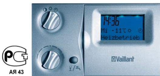
Регулятор обеспечивает регулирование температуры двух контуров: подающей линии отопительного контура и смесительного контура в зависимости от погодных условий с помощью датчика наружной температуры. Кроме того, он может управлять приготовлением горячей воды и циркуляционным насосом.
