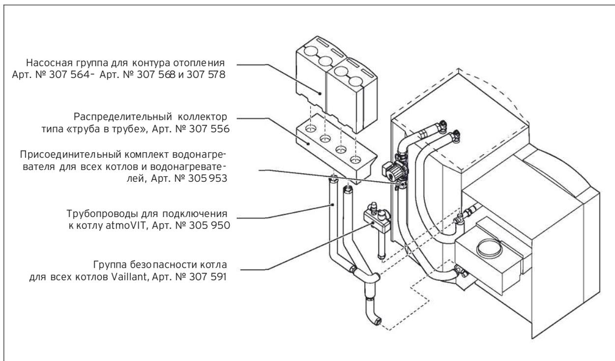
Пример: Фрагмент общей системы принадлежностей для подключения котла atmoVIT.
