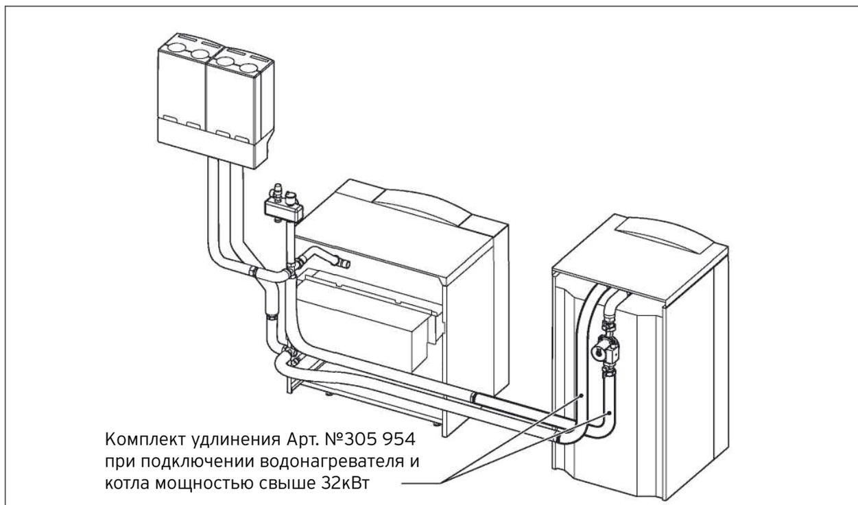
Пример установки котла мощностью более 32 кВт и водонагревателя слева (вид на оборудование спереди) рядом с котлом, с соединительным комплектом водонагревателя и удлинением соединительного комплекта водонагревателя № 305954.
