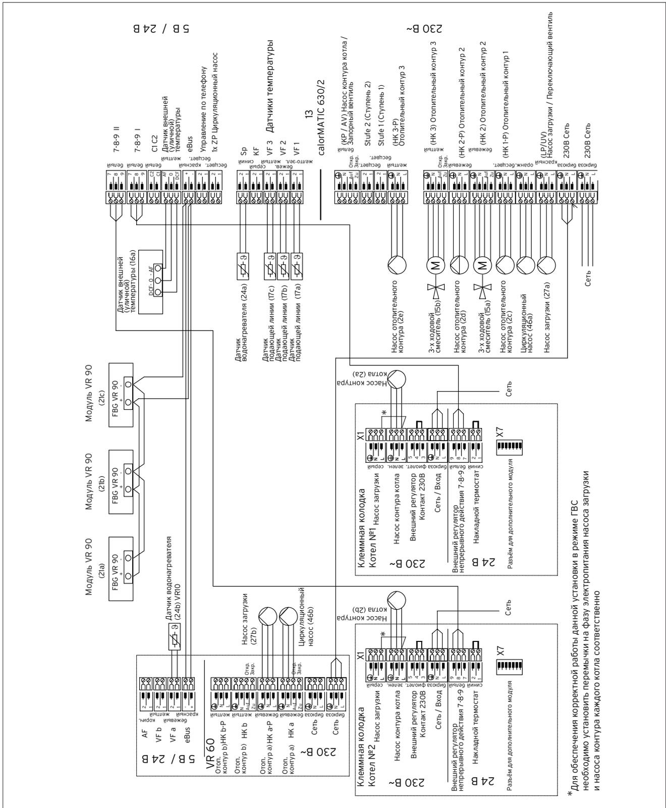
\* Для обеспечения корректной работы данной установки в режиме ГВС необходимо установить переключки на фазу электропитания насоса загрузки и насоса контура каждого котла соответственно
