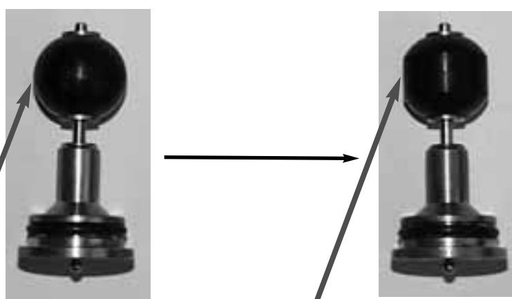
Для уменьшения сопротивления при движении клапана боковая поверхность вместо сферической выполнена цилиндрической.
