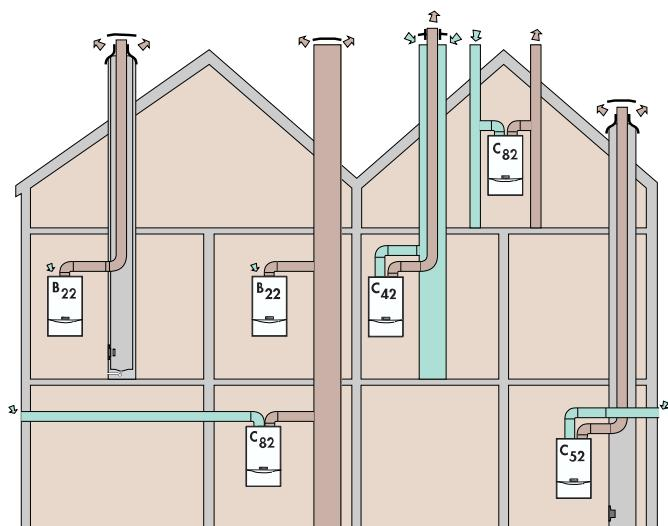
Возможности применения системы 2 для подвода воздуха и отвода отходящих газов
