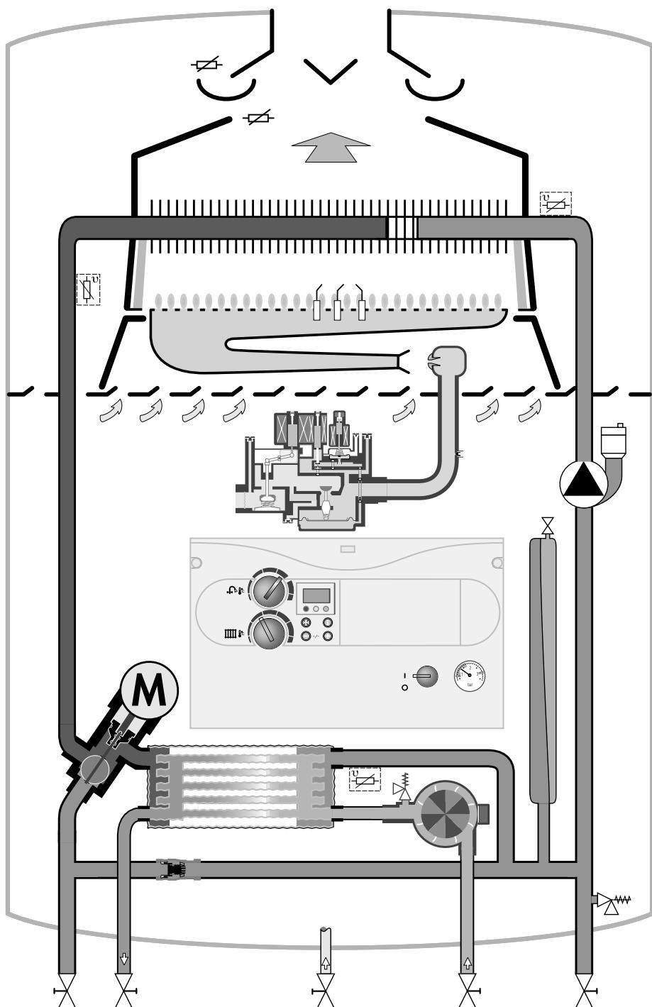
Функциональная схема atmoMAX Plus VUW (Режим приготовления горячей воды)
