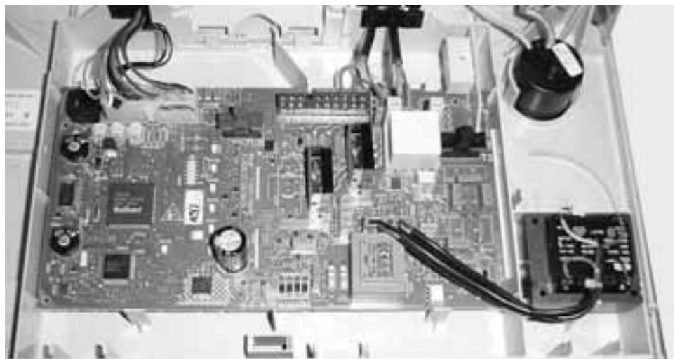
Электронный блок со снятыми крышками, вид сзади
