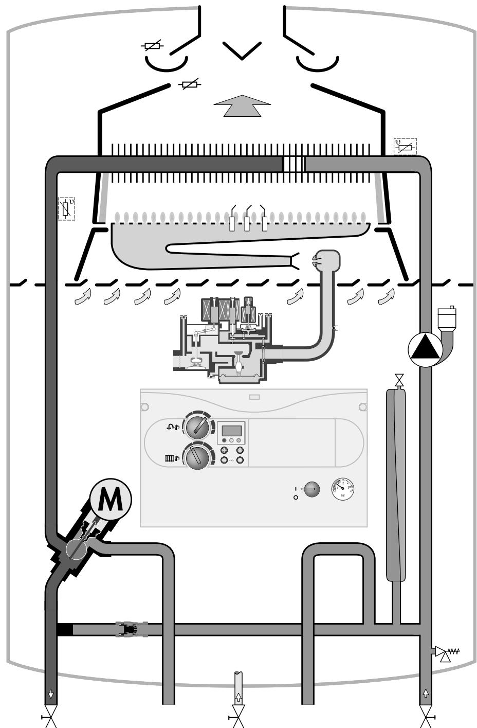
Функциональная схема atmoMAX Plus VU со встроенным приоритетным переключающим вентилем (Режим отопления)
