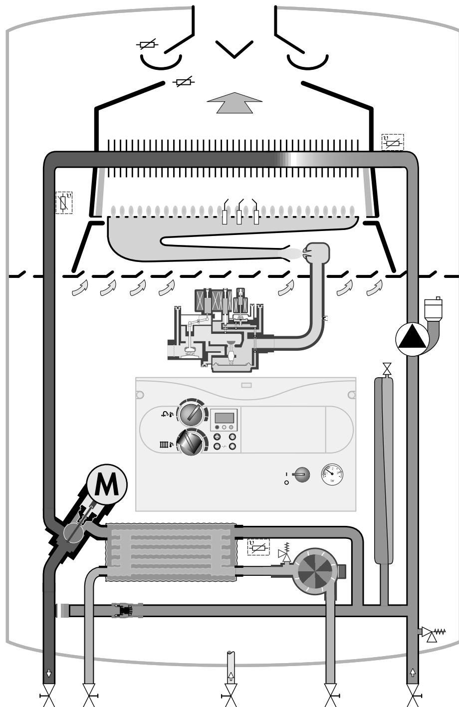
Функциональная схема atmoMAX Plus VUW (Режим отопления)
