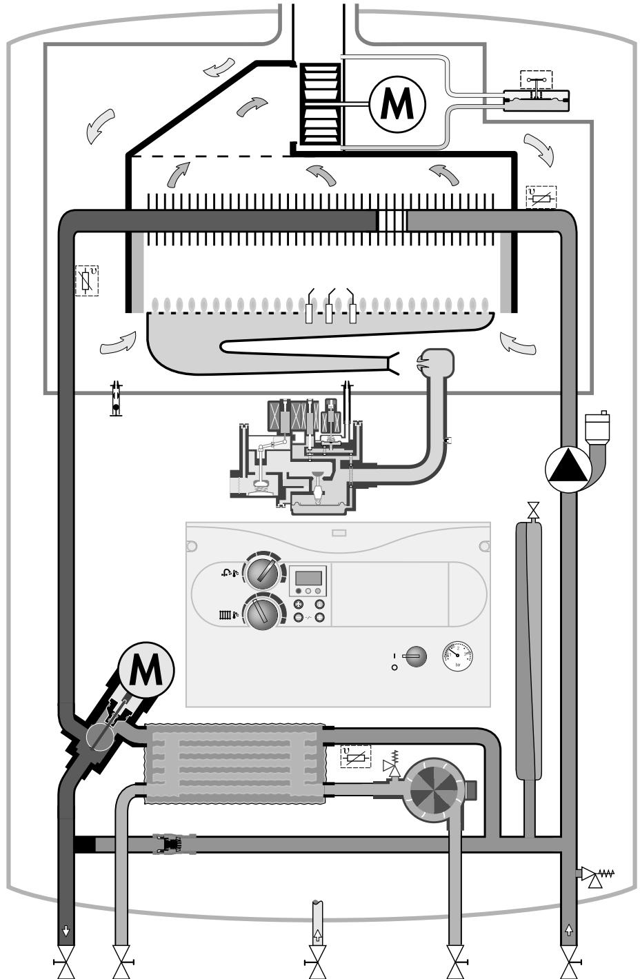
Функциональная схема turboMAX Plus VUW (Режим отопления)
