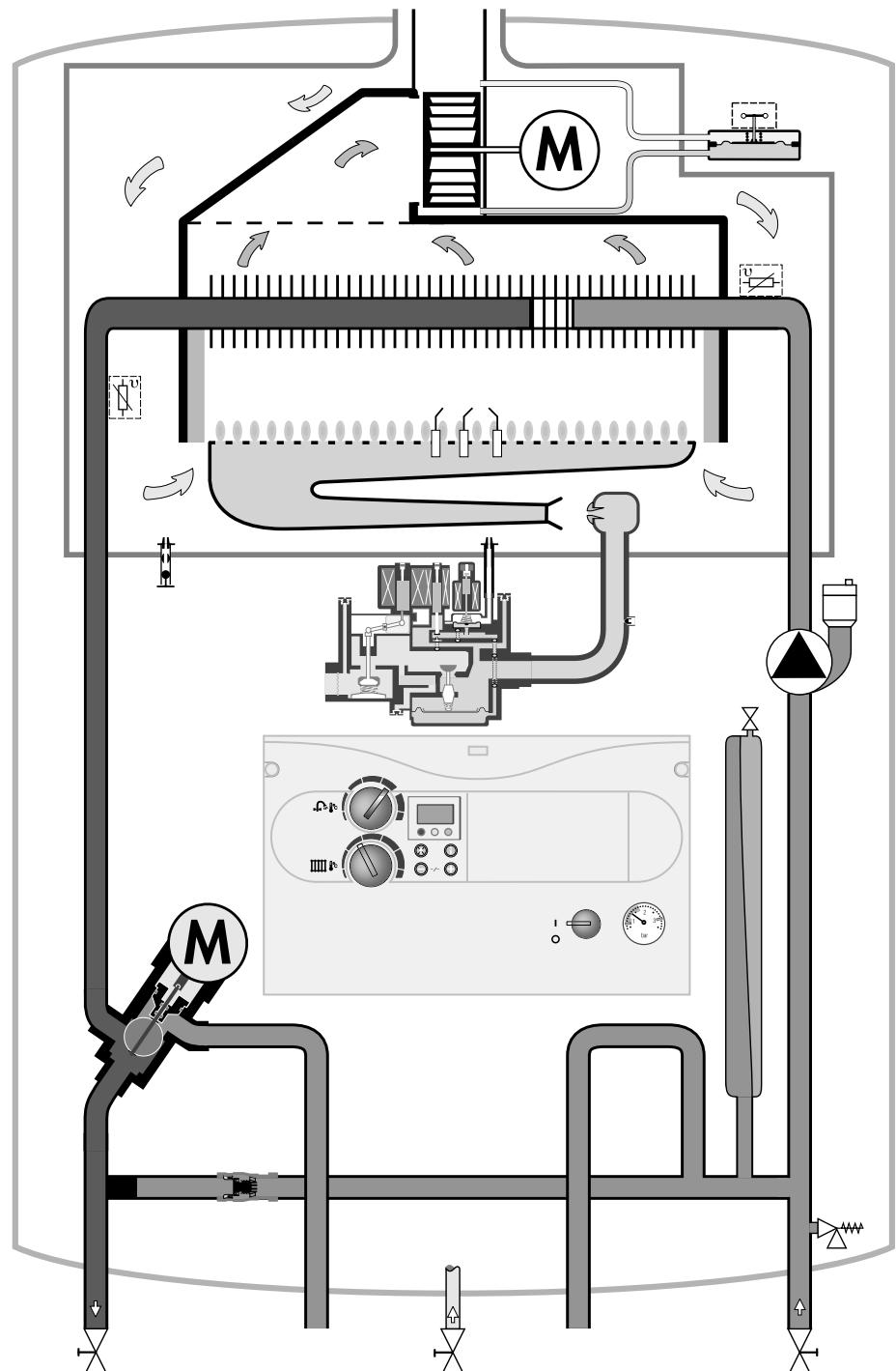
Функциональная схема turboMAX Plus VU со встроенным приоритетным переключающим вентилем (Режим отопления)
