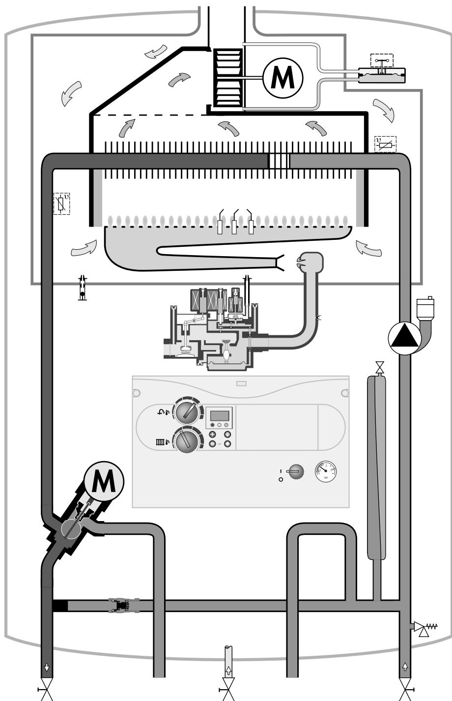
Функциональная схема turboMAX Plus VU со встроенным приоритетным переключающим вентилем (Режим отопления)
