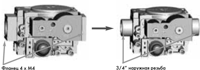
Новый газовый тракт (см. стр.40) состоит из оцинкованной стальной трубы (a), на 180° повернутой газовой арматуры (b) с двумя герметизирующими кольцами прямоугольного сечения 16x24x1,5, верхней газовой трубы из меди (c) и, при потребности, предварительного сопла.
