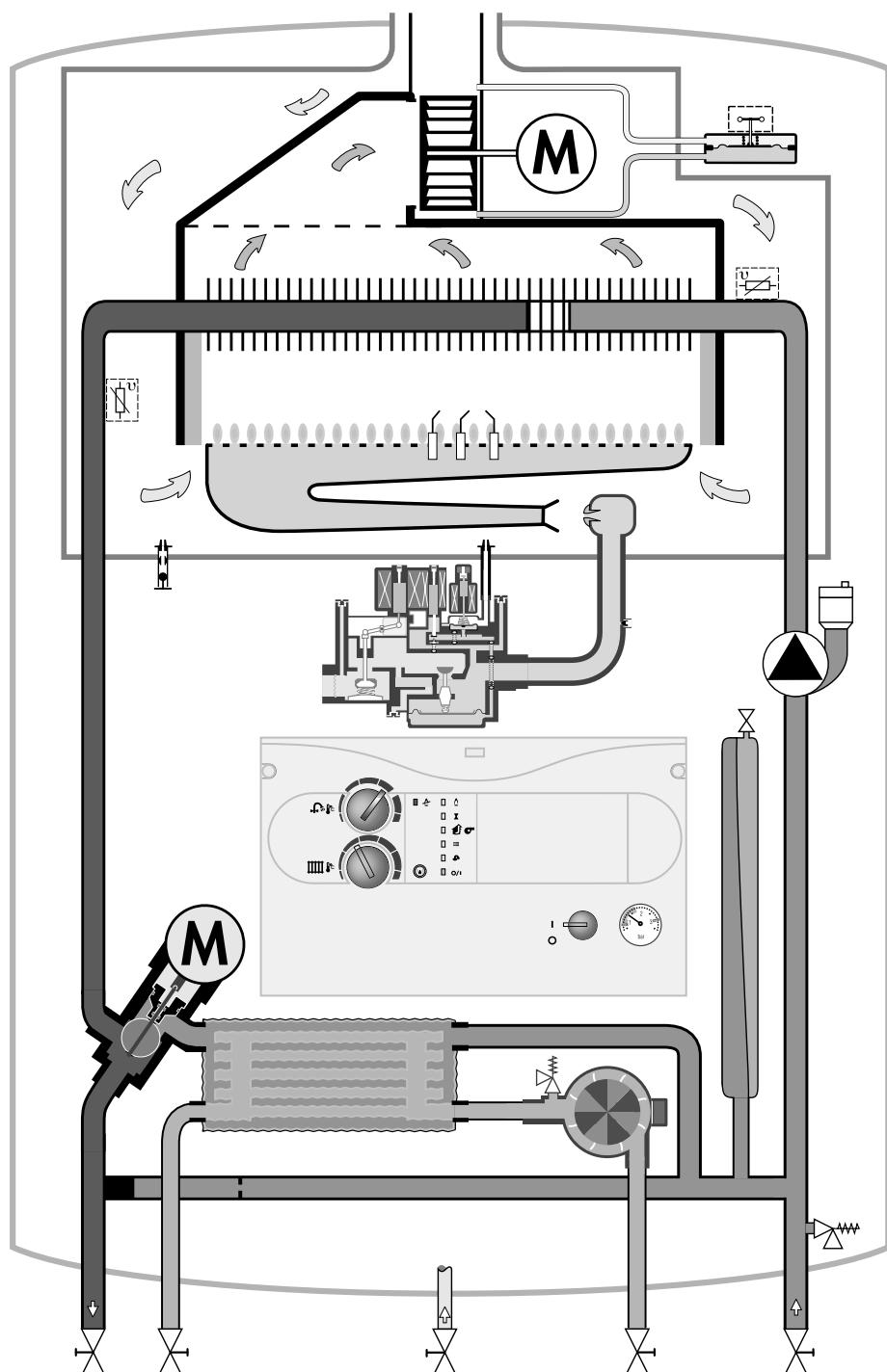
Функциональная схема turboMAX Pro VUW (Режим отопления)
