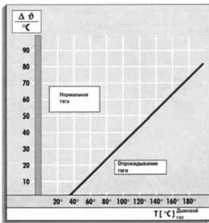
Характеристика дифференциального датчика отходящих газов
