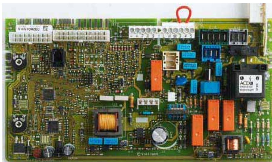
Электронная плата котла
