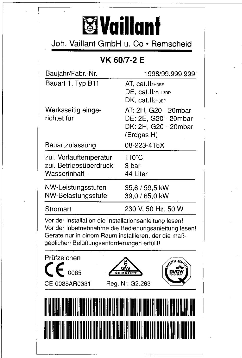
Рис. 2.1 Пример шильдика.
