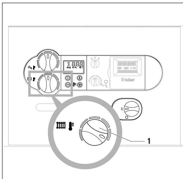
Sl. 4.6 Nastavitev dotočne temperature z regulacijsko napravo
