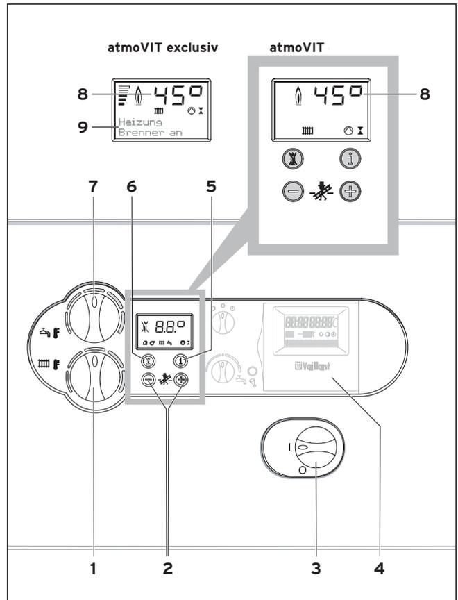
Fig. 4.3 Elementele componente
