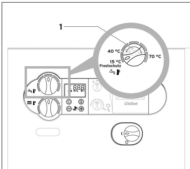
Рис. 4.5 Нагрев воды (только при подключенном емкостном водонагревателе)
