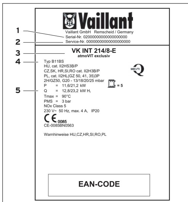
**Рис. 2.1 Табличка с указанием типа аппарата (пример)**
