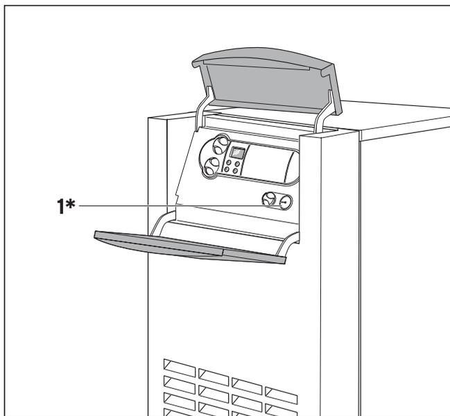
Рис. 4.1 Проверить давление воды в системе отопления
