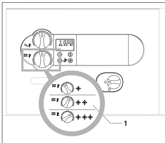
Slika 4.7 Namještanje temperature u polaznom vodu na kotlu
