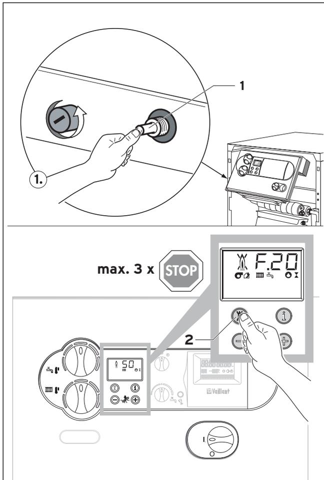
Рис. 5.2 Разблокировка после отключения предохранительного ограничителя температуры
