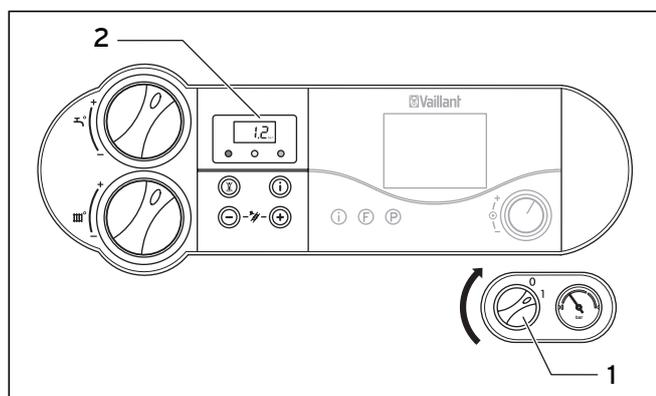
Рис. 4.5 Включение прибора
