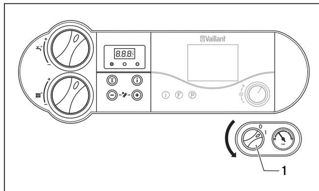
Рис. 4.16 Отключение прибора
