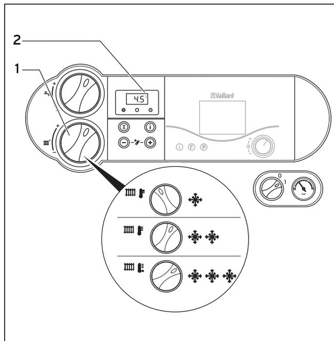
Рис. 4.8 Настройка температуры подающей линии при отсутствии регулирующего прибора
