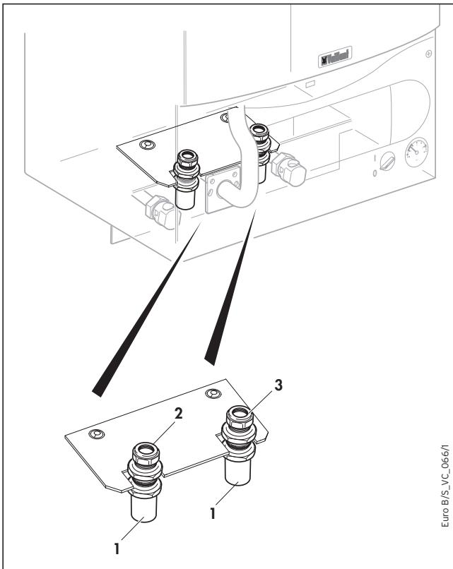
Рис. 3.10 Монтаж присоединения к системе водоснабжения (VU)
