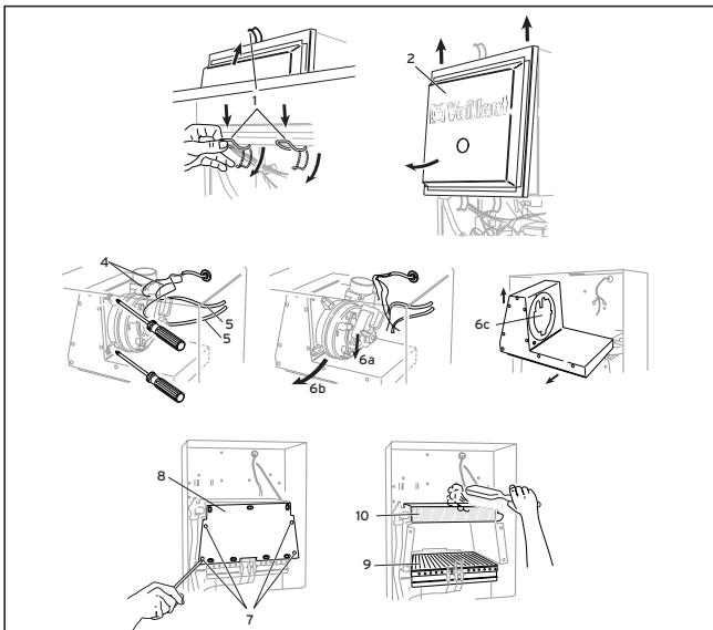
Рис. 7.1б Чистка горелки и первичного теплообменника VU/VUW 202/2-5, 242/2-5, 282/2-5
