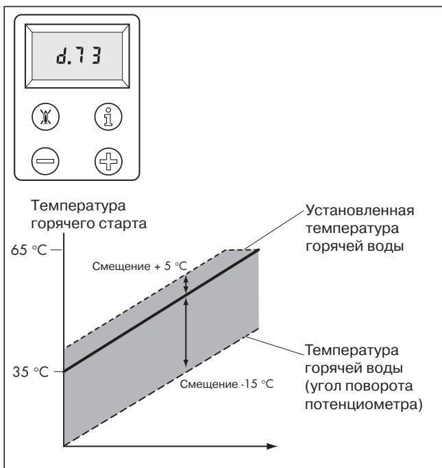
Рис. 6.9 Регулировка температуры горячего старта
