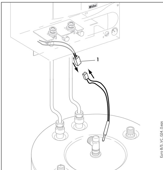
Рис. 3.19 Подключение водонагревателя
