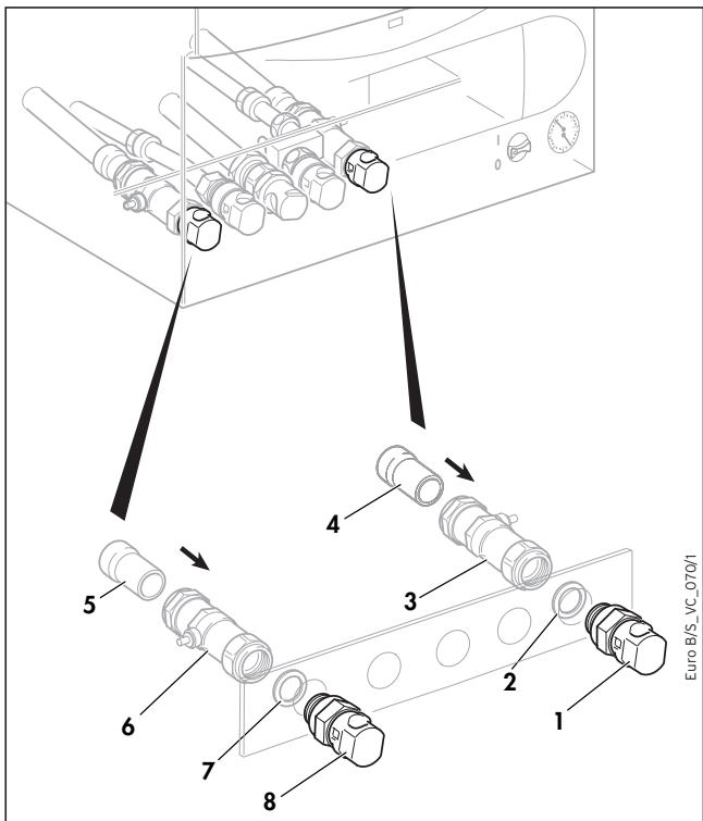
**Рис. 3.11 Подсоединение подающего и обратного трубопроводов отопительной системы (VUW)**
