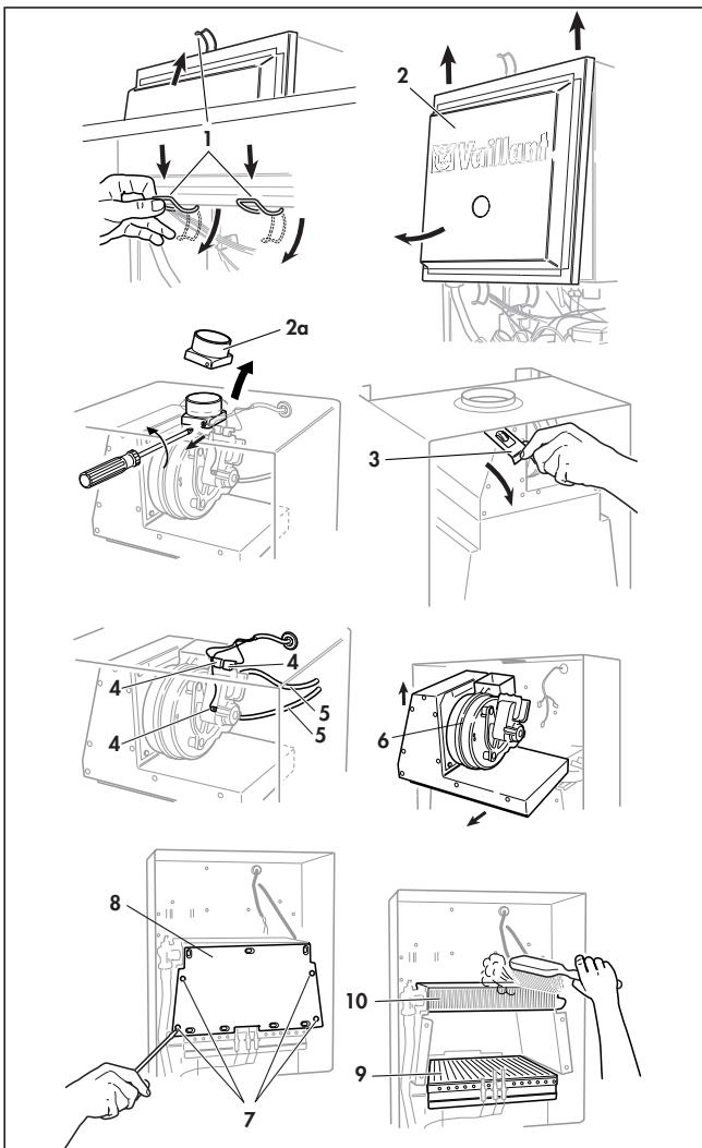
Рис. 7.1а Чистка горелки и первичного теплообменника VU 122/2-5
