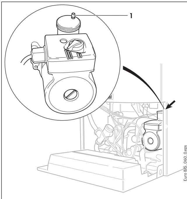
Рис. 3.20 Автоматический воздухоотводчик
