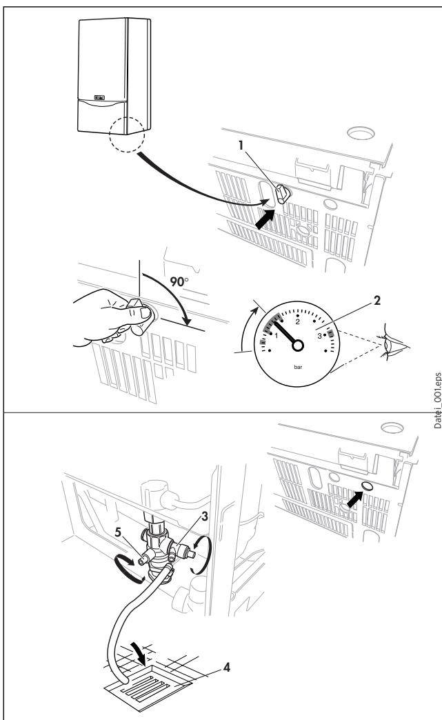
**Рис. 7.3 Заполнение системы отопления/Опорожнение системы отопления (VUW)**
