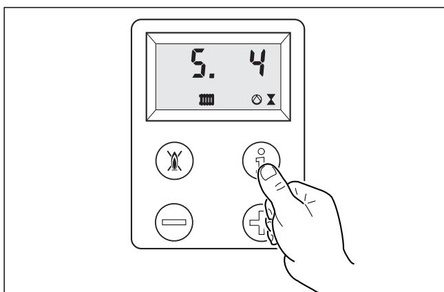
Рис. 5.3 Индикация на дисплее при режиме отопления
