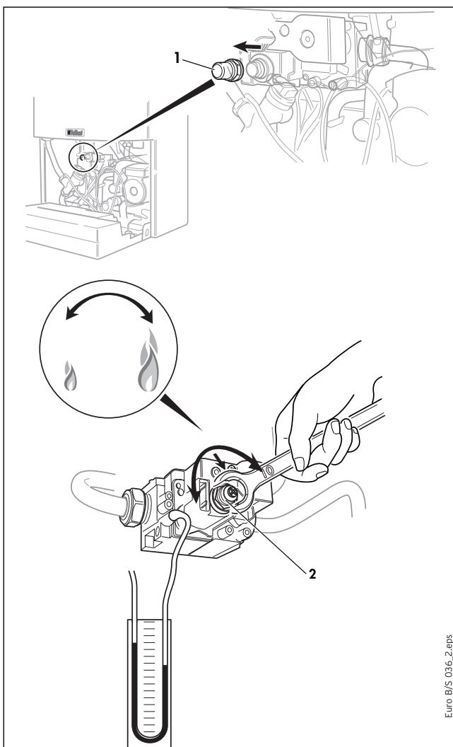
**Рис. 4.3 Настройка максимальной тепловой мощности (номинальной мощности)**
