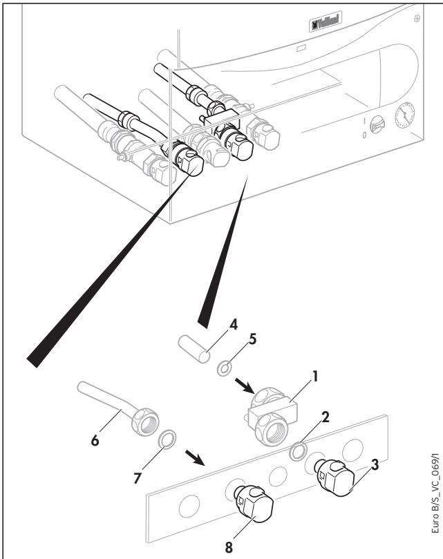
Рис. 3.9 Монтаж присоединения к системе водоснабжения (VUW)
