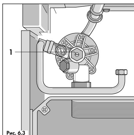
Для того, чтобы увеличить температуру горячей воды, регулировочный винт ограничителя расхода воды (1, рис. 6.3) поворачивается подходящей отверткой вправо, чтобы уменьшить расход воды в кране, пока не будет достигнута желаемая температура воды.
