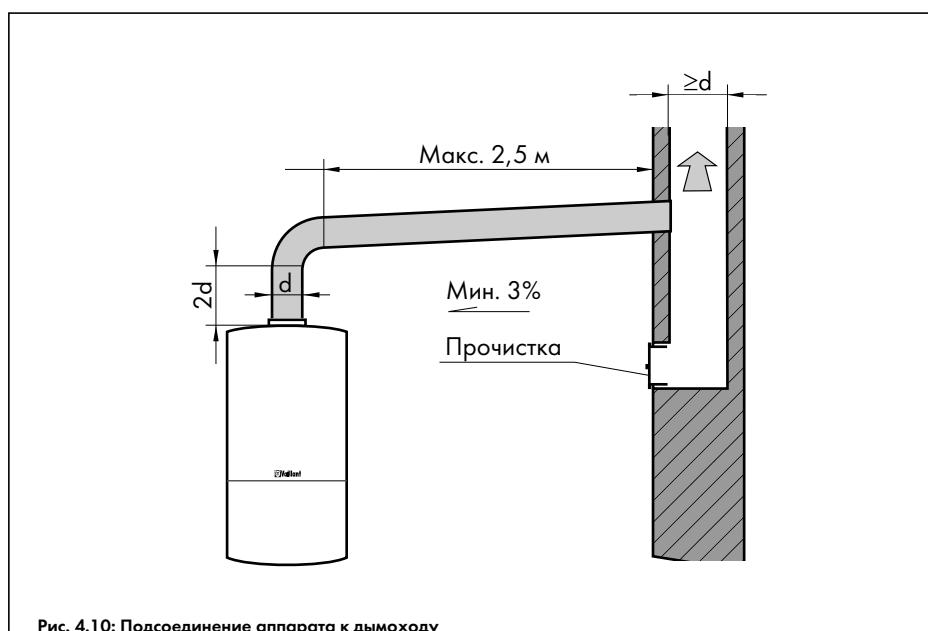
Рис. 4.10: Подсоединение аппарата к дымоходу
