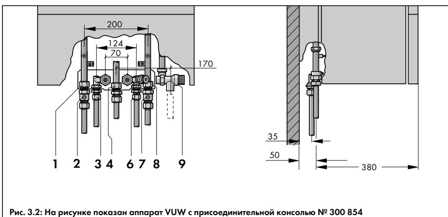
Рис. 3.2: На рисунке показан аппарат VUW с присоединительной консолью № 300 854
