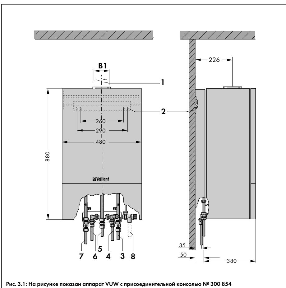
Рис. 3.1: На рисунке показан аппарат VUW с присоединительной консолью № 300 854
