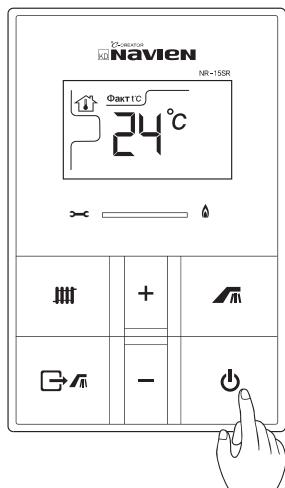
При нажатии на кнопку со значком на дисплее отобразятся символы, относящиеся к последнему установленному на выносном пульте режиму, и котёл автоматически запустится. Котёл начнёт работать в режиме, отображаемом на дисплее выносного пульта. Если вам не подходит текущий режим работы котла, то его можно изменить.
