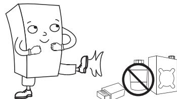
2. Не допускается хранить в помещении, где установлен котёл, химически активные вещества, такие как амиак, хлор, сера и различные кислоты.
