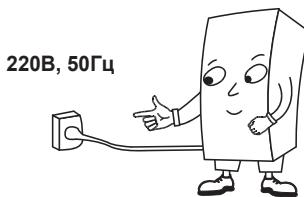
2. Не подключайте к источнику питания другие электроприборы параллельно с котлом. Не используйте при подключении удлинители и переходники.
