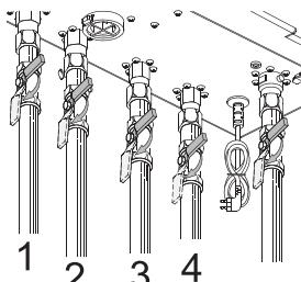
**3.5.Откройте сливную заглушку, расположенную внизу котла и сплейте отопительную воду.**
