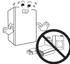
2. Не допускается хранить в помещении, где установлен котёл, химически активные вещества, такие как амиак, хлор, сера и различные кислоты.
