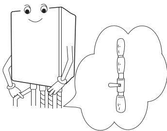
**Сливайте воду из контура отопления и контура горячего водоснабжения, если котёл не будет использоваться в течение длительного периода.**
