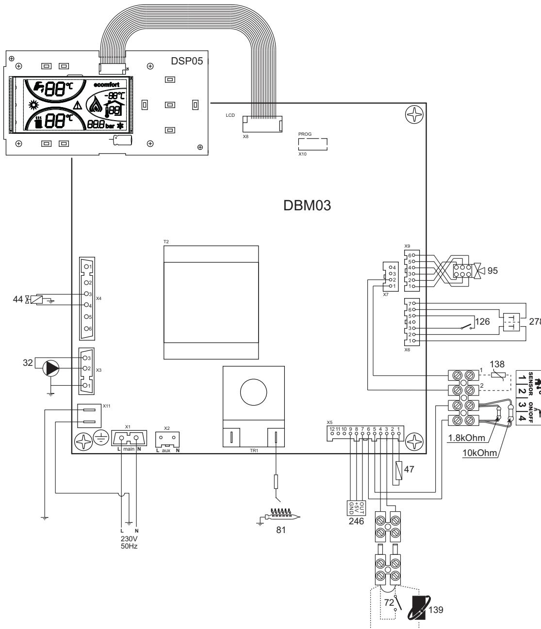
рис. 25 - Электрическая схема
