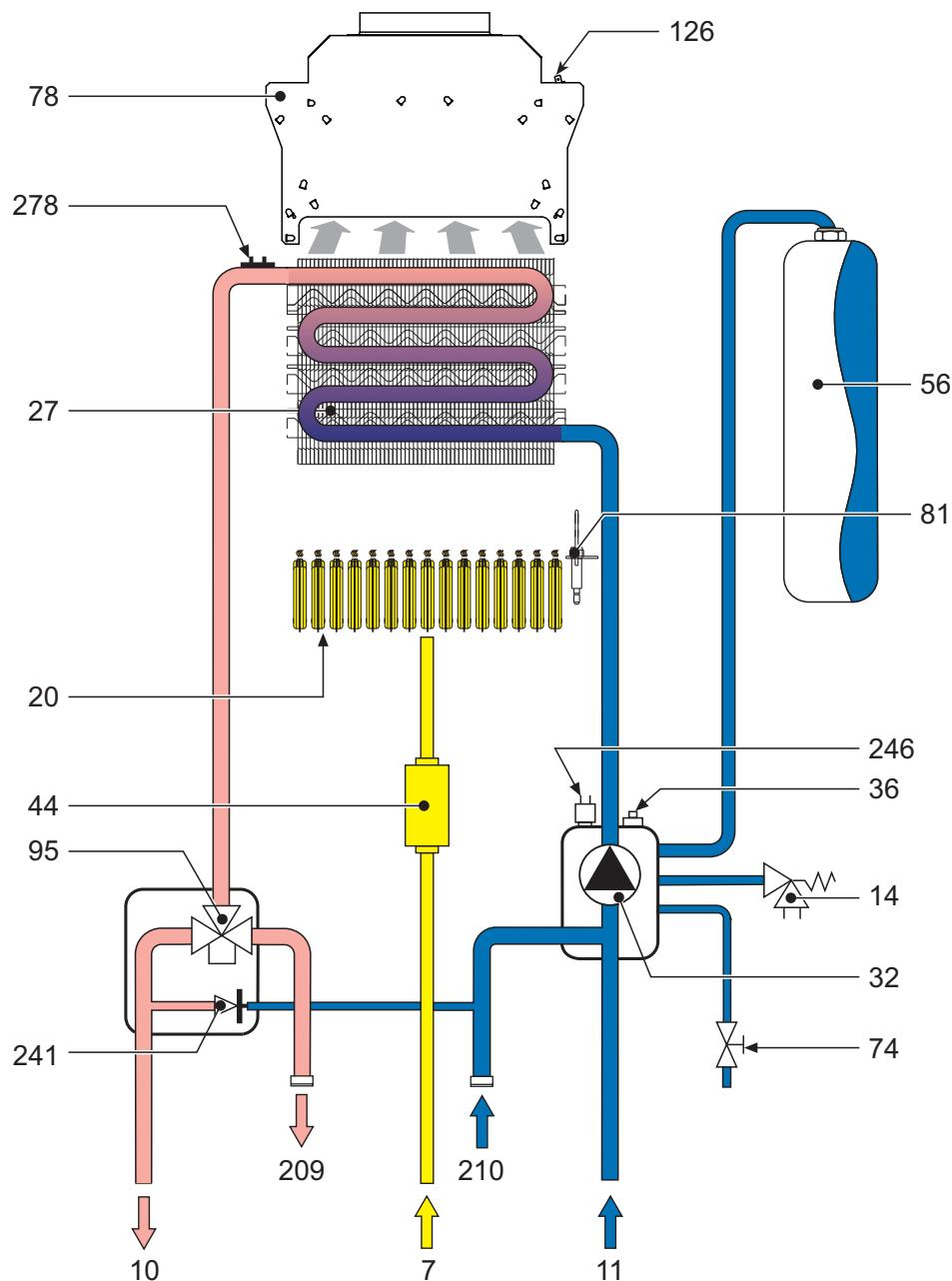
рис. 24 - Схема системы отопления и контура ГВС
