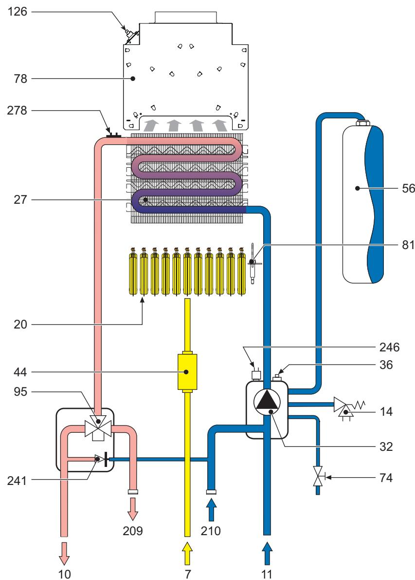
рис. 24 - Схема системы отопления и контура ГВС
