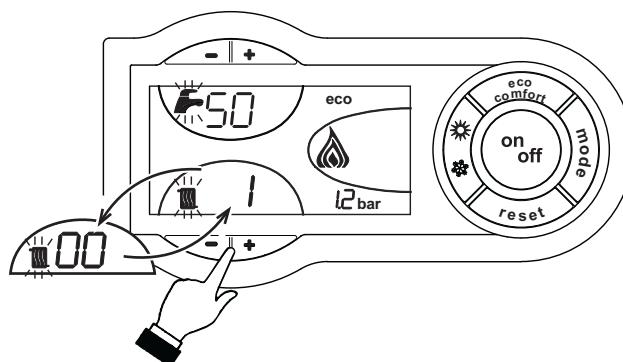
рис. 19 - Режим TEST (мощность отопления = 100%)
