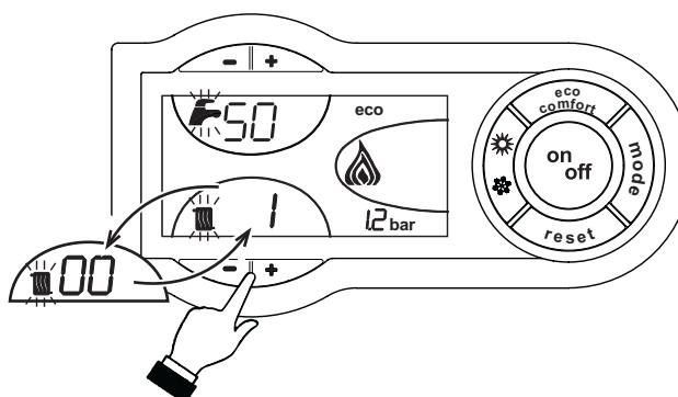
рис. 20 - Режим TEST (мощность отопления = 100%)
