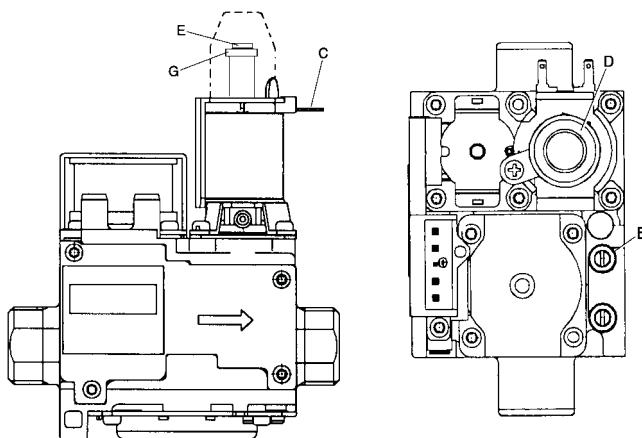
рис. 21 - Газовый клапан
