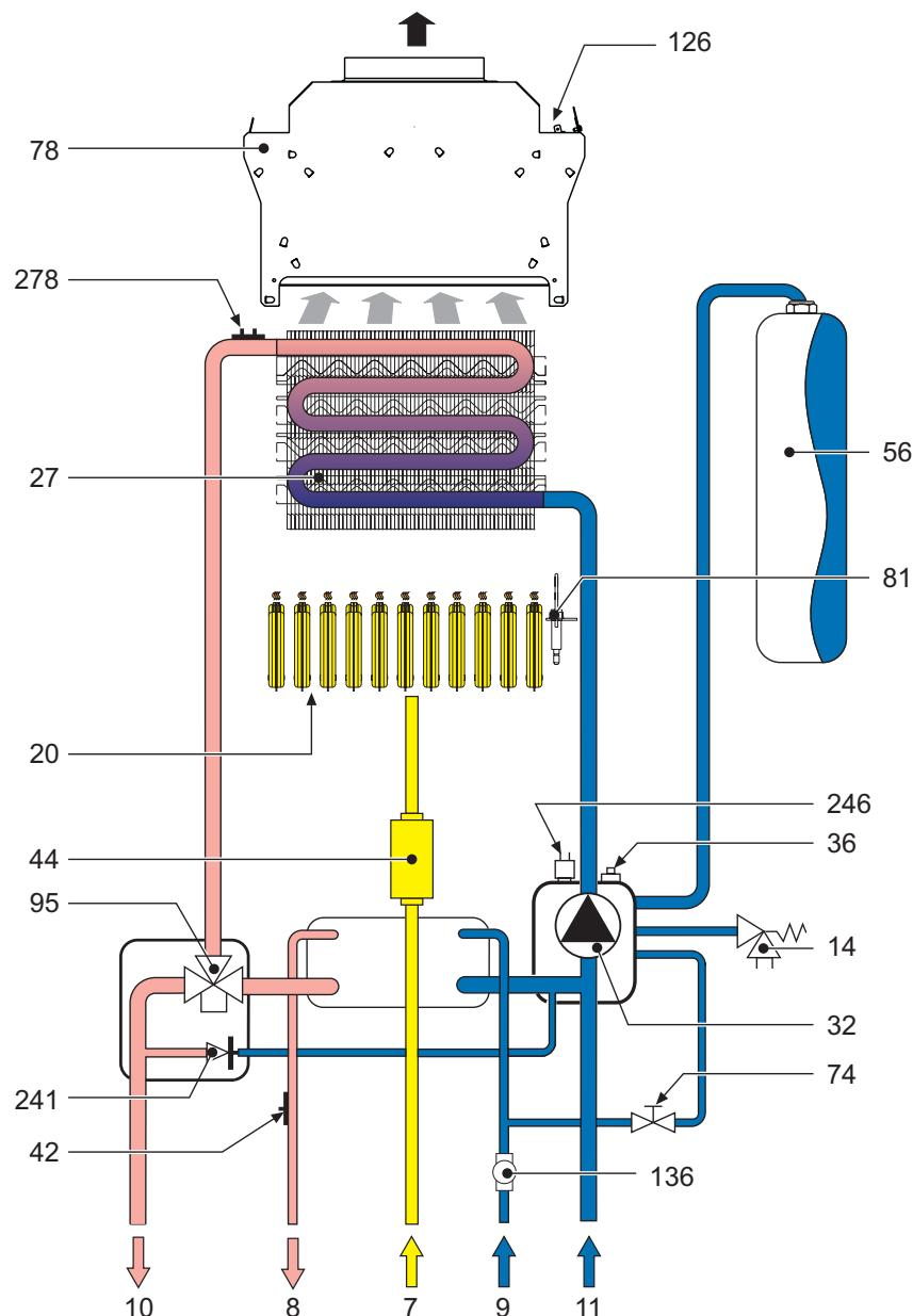
рис. 25 - Схема системы отопления и контура ГВС
