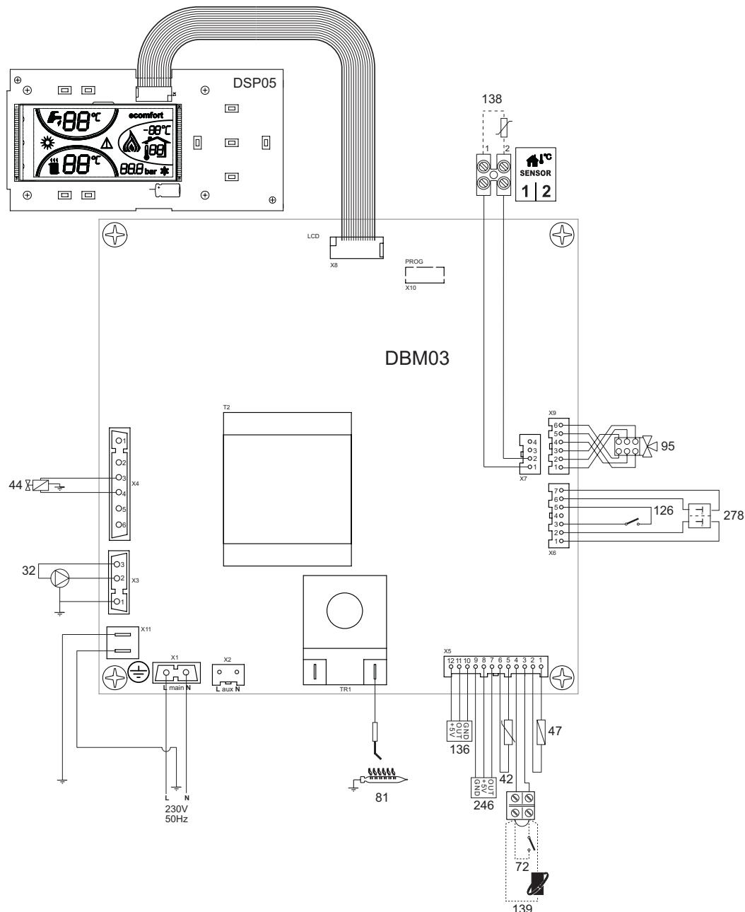
рис. 26 - Электрическая схема
