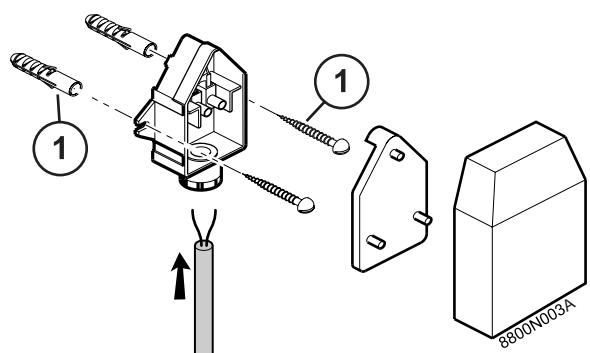
Датчик наружной температуры крепится на наружной стене при помощи поставляемых принадлежностей : 2 шурупов СВ диам. 4 + дюбели.
