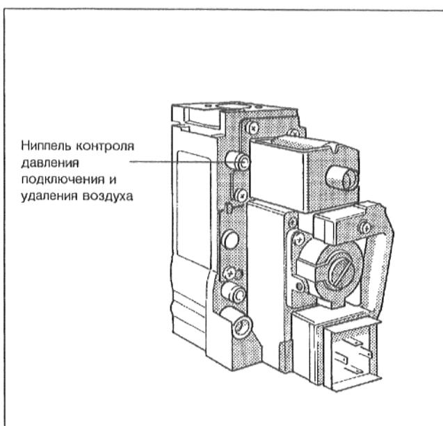
Рис. 15: Арматура газовой горелки "Honeywell" VR 4601
