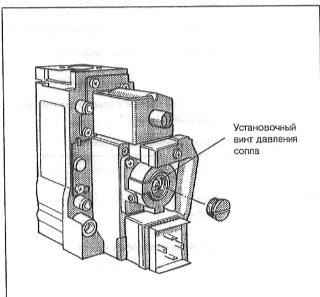
Рис. 38: Арматура газовой горелки "Honeywell" VR 4601
