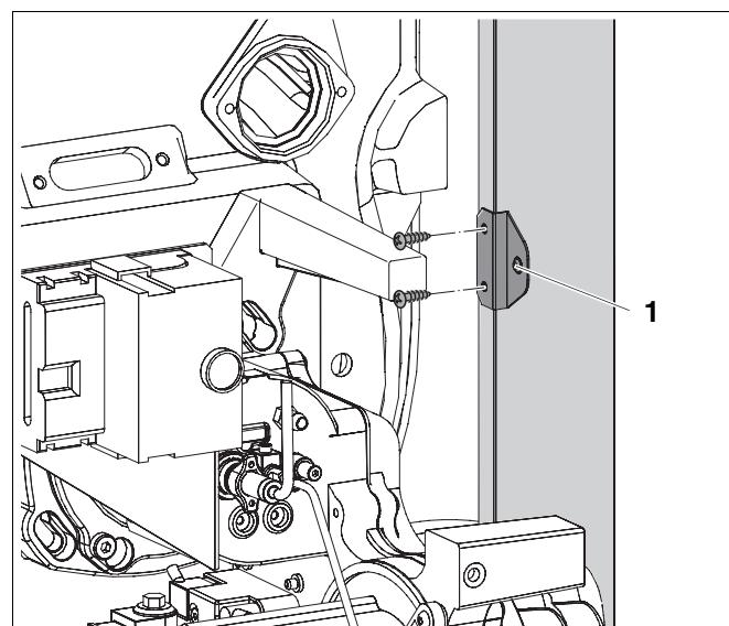
Рис. 44 Установка уголка на боковых стенах
