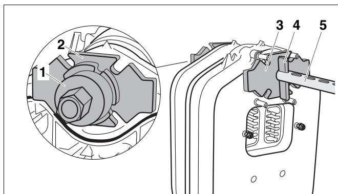
Рис. 14 Установка стяжного инструмента на верхней ступице котла
