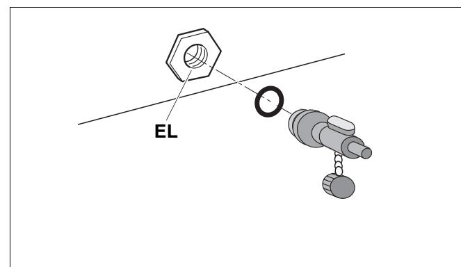
Рис. 58 Установка крана для наполнения и слива
