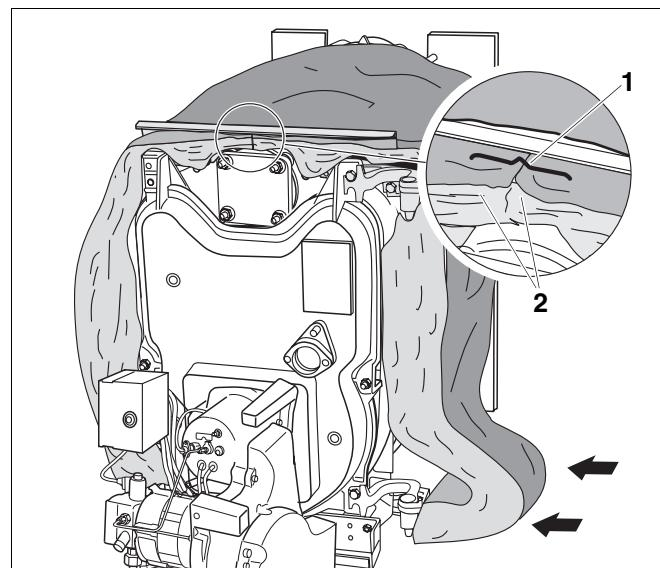
Рис. 38 Монтаж теплоизоляции
