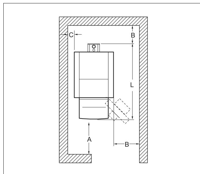
Рис. 4 Расстояния от стен в помещении
