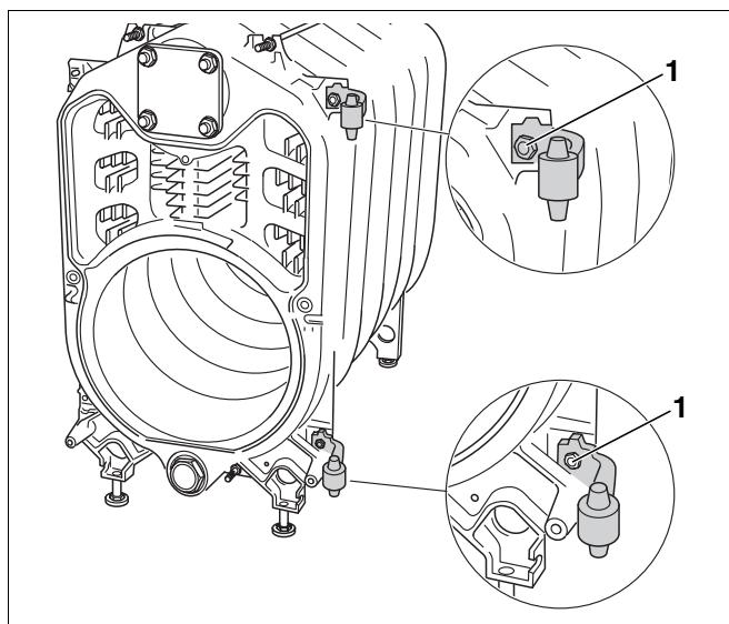
Рис. 32 Монтаж шарнирных крюков (здесь: с правой стороны)
