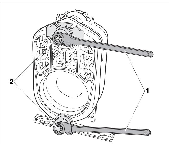
Рис. 16 Затяжка стяжных гаек ключами с трещоткой.
