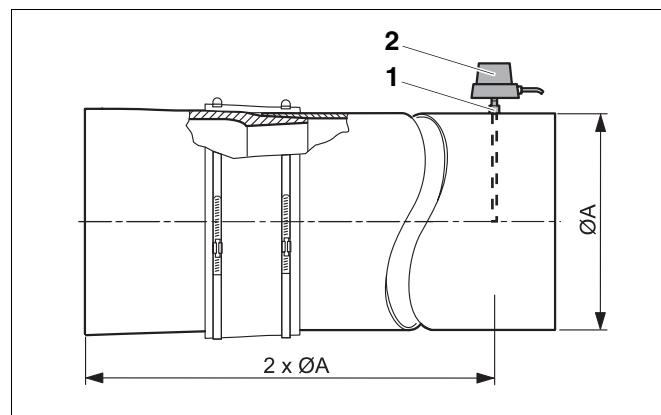
Рис. 54 Установка датчика температуры дымовых газов (принципиальная схема)
