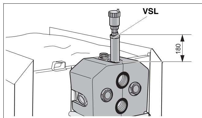
Рис. 56 Установка воздушного клапана на предохранительной подающей линии
