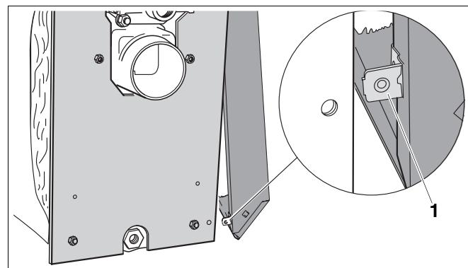
Рис. 43 Соединение винтами боковой и задней стенок
