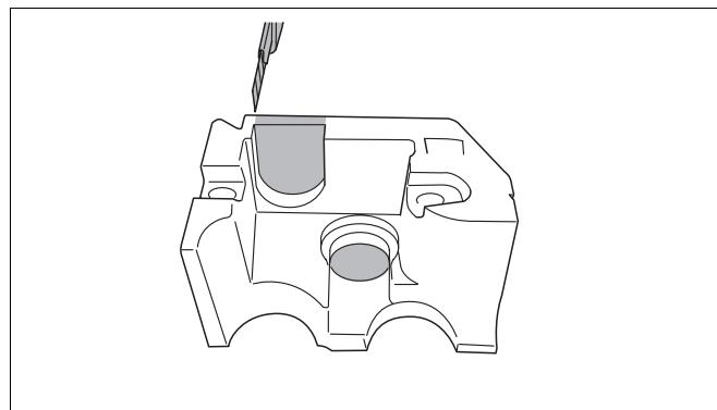
Рис. 48 Вырезание изоляции
