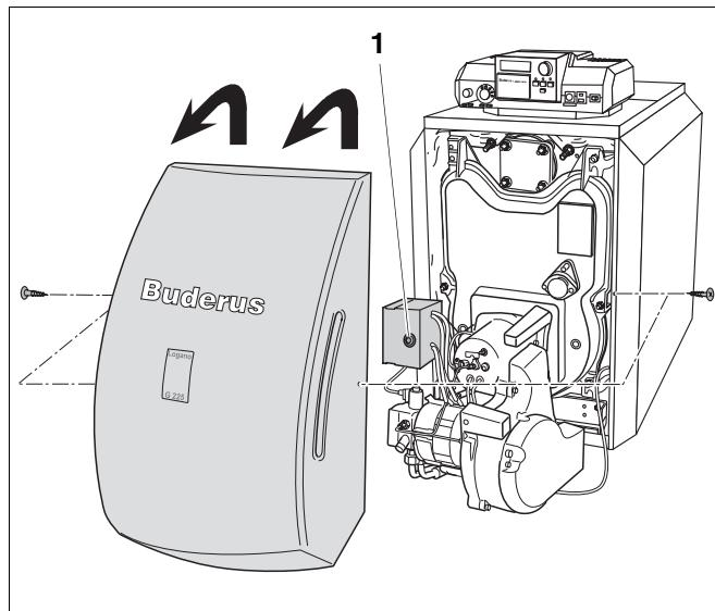
Рис. 76 Разблокирование горелки
