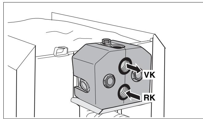
Рис. 55 Подключение подающей и обратной линий отопления
