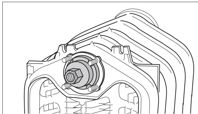
Рис. 17 Установка стяжного инструмента на переднюю секцию котла
