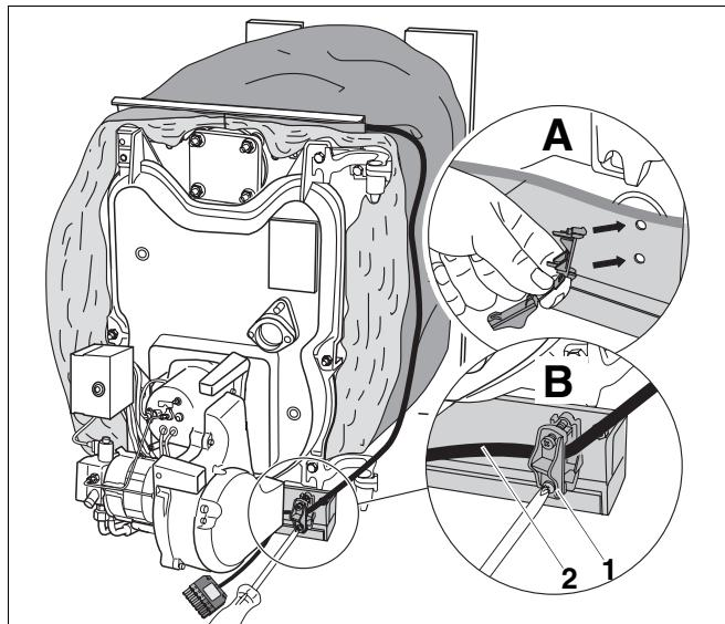
Рис. 39 Установка фиксатора провода и прокладка кабеля горелки
