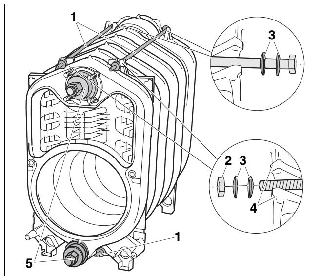
Рис. 18 Установка анкерных штанг – расположение тарельчатых пружин
