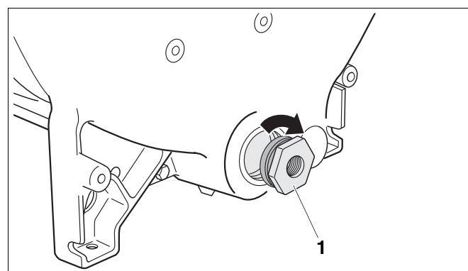
Рис. 25 Установка переходника
