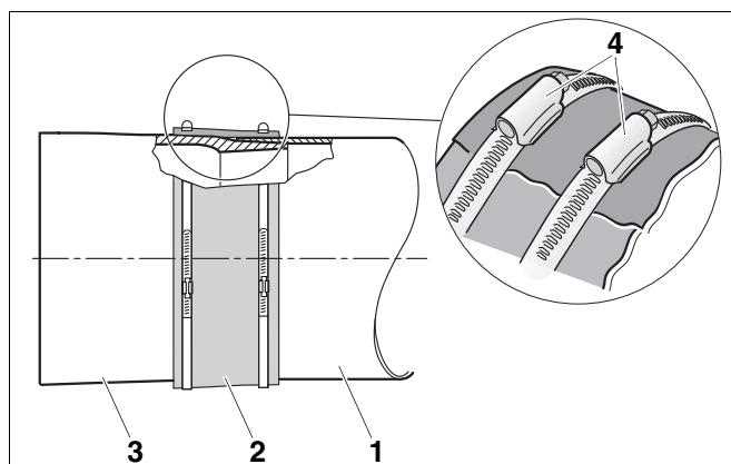
Рис. 52 Установка уплотнительной манжеты дымовой трубы (принципиальная схема)
