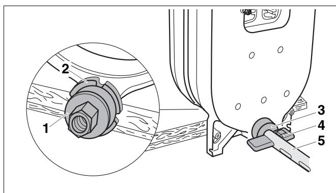
Рис. 15 Установка стяжного инструмента на нижней ступице котла
