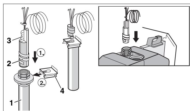
Рис. 63 Установка комплекта температурных датчиков
