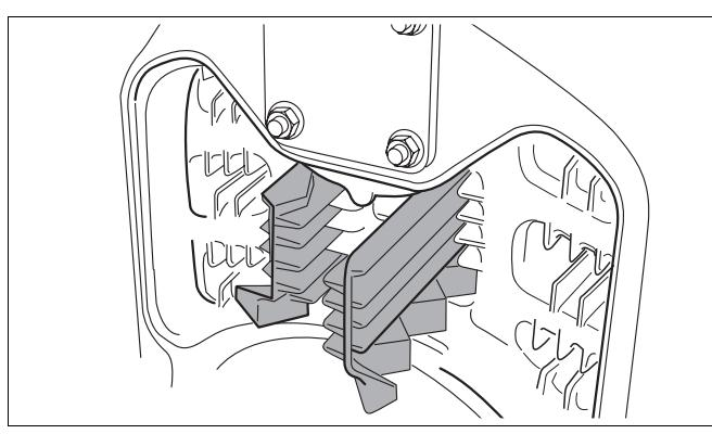
Рис. 31 Укладка направляющих пластин дымовых газов в 3-ий газоотводящий канал
