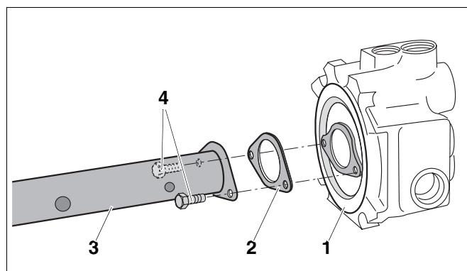
Рис. 19 Установка подпиточной трубы и соединительного элемента
