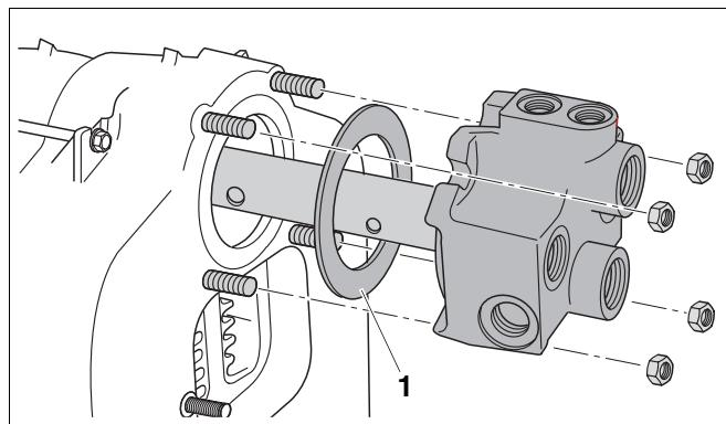
Рис. 20 Установка подпиточной трубы и соединительного элемента
