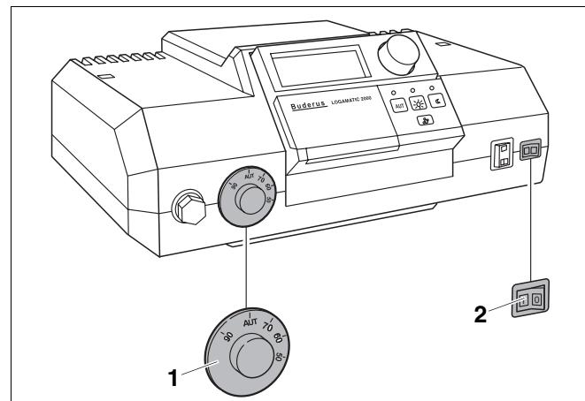
Рис. 67 Включение системы управления
