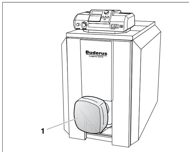
Рис. 5 Разблокирование горелки
