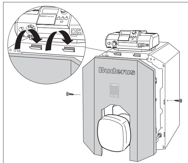
Рис. 38 Установка облицовки дверцы горелки
