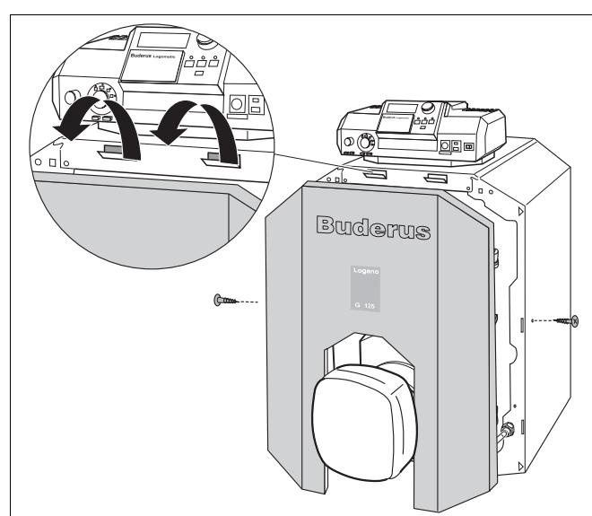
Рис. 10 Демонтаж кожуха горелки
