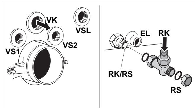
Рис. 19 Подключение подающей и обратной линий
