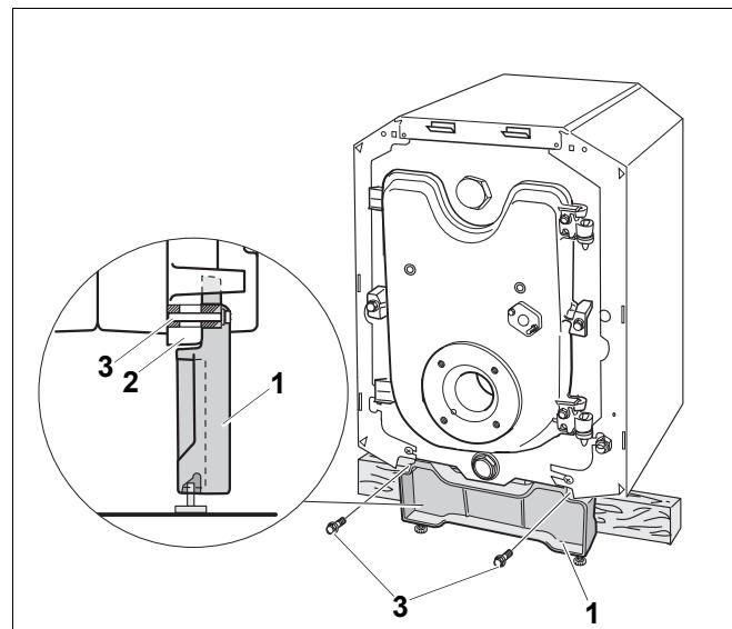
Рис. 9 Монтаж подставки под передней секцией котла
