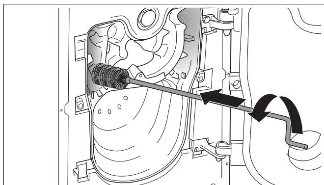
Рис. 41 Чистка щеткой газоотводящих каналов.
