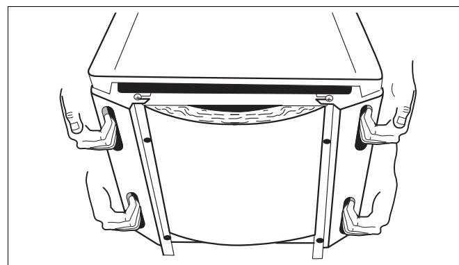
Рис. 12 Подъем и перенос отопительного котла
