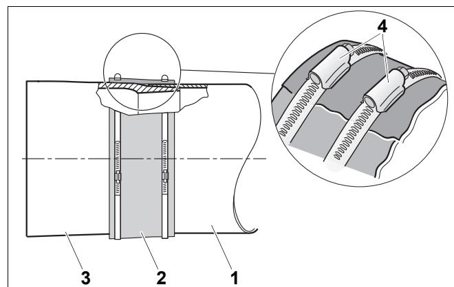
Рис. 14 Установка уплотнительной манжеты дымовой трубы (принципиальная схема)
