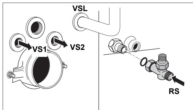
Рис. 21 Подключение бака-водонагревателя
