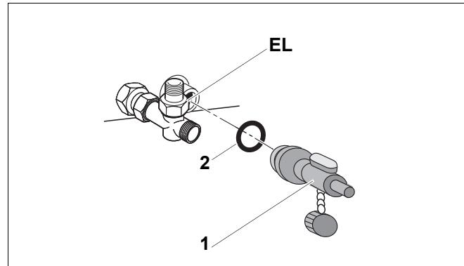
Рис. 22 Установка крана для наполнения и слива
