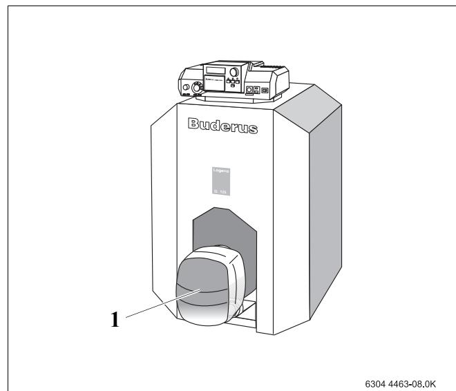
Рис. 44 Разблокирование горелки (котел с вентиляторной горелкой)
