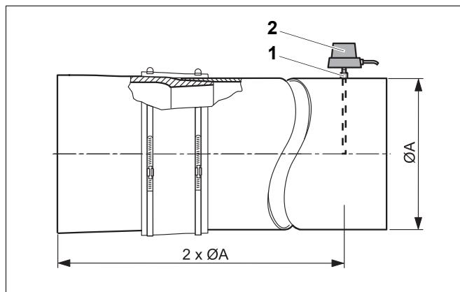
Рис. 16 Установка датчика температуры дымовых газов (принципиальная схема)
