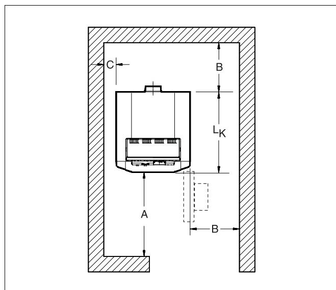
Рис. 3 Расстояния от стен в помещении
