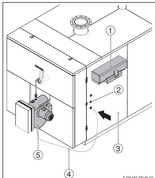
Рис 34 Монтаж кабеля горелки у котлов 1400 - 1850 кВт
