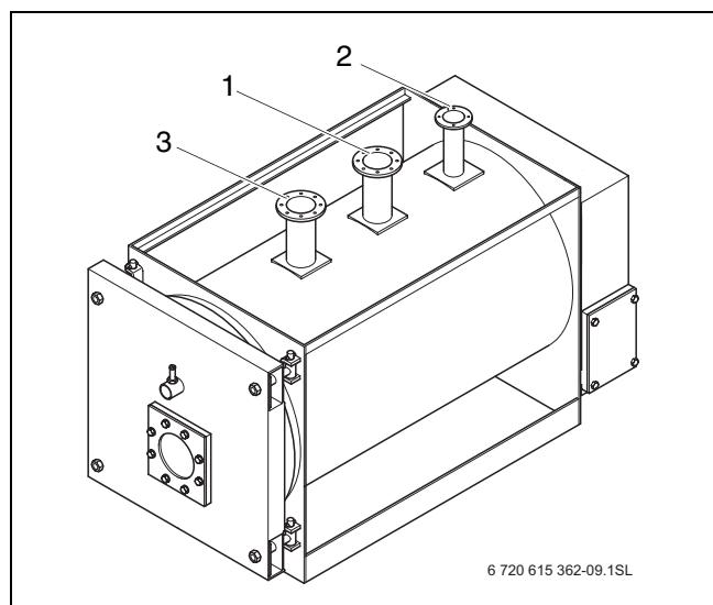
Рис 10 Отопительный котёл Logano 120 - 1200 кВт
