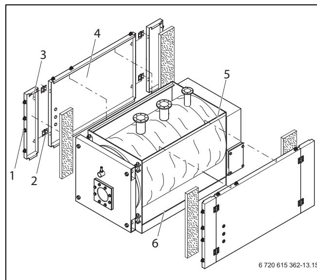
Рис 17 Монтаж боковых стенок в котлах 120 - 420 кВт
