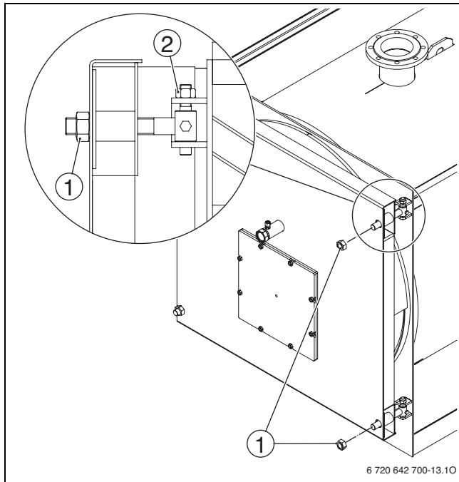
Рис 12 Открытие дверцы горелки у котлов 120 - 1200 кВт
