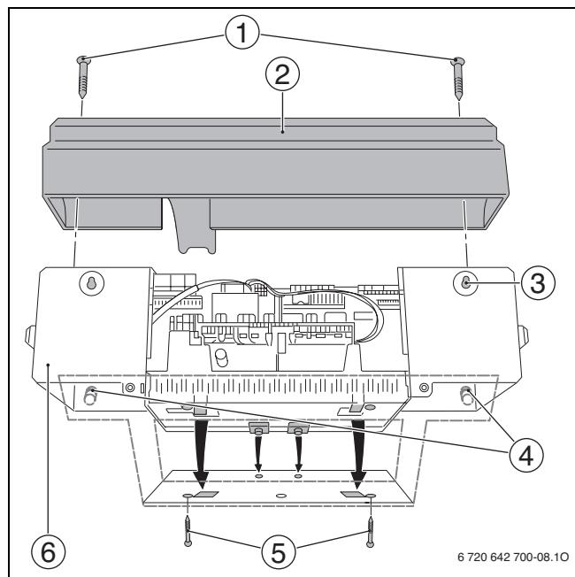
Рис 30 Монтаж системы управления на котлах 1400 - 1850 кВт
