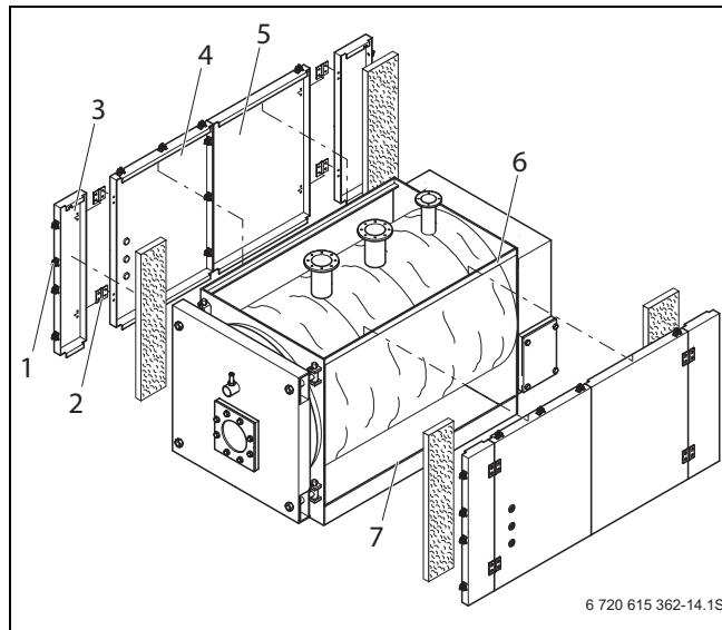
Рис 18 Монтаж боковых стенок в котлах 500 - 1200 кВт
