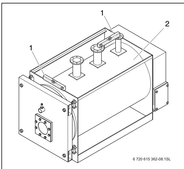
Рис 9 Выравнивание котла
