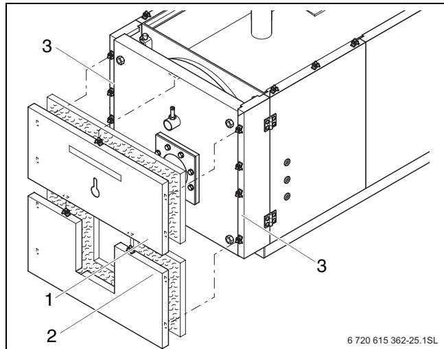
Рис 23 Монтаж обшивки двери на котлах 120 - 1200 кВт
