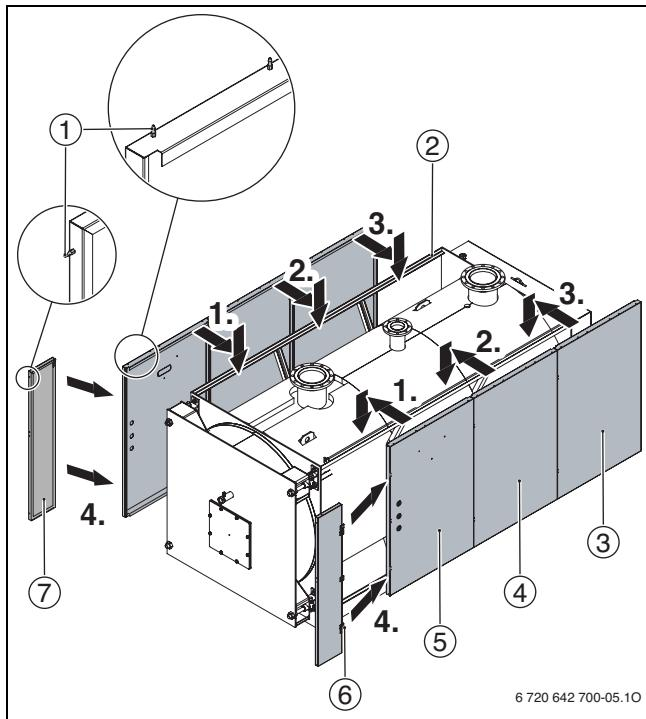
Рис 20 Монтаж боковых стенок в котлах 1400 - 1850 кВт
