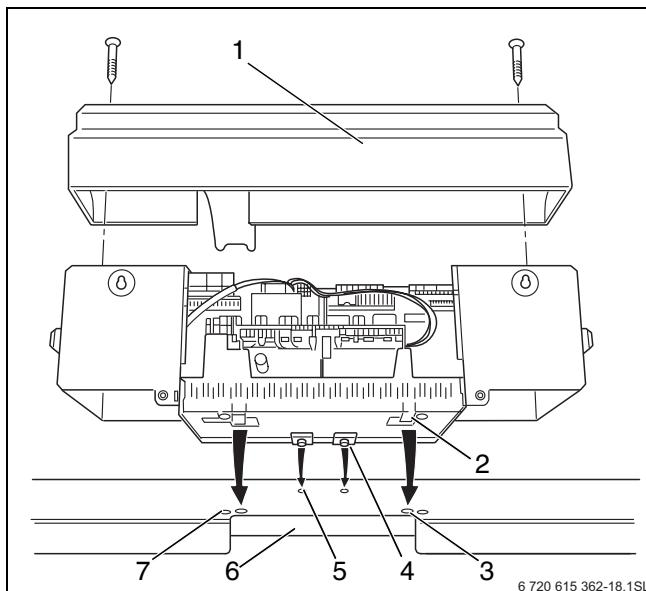
Рис 29 Монтаж системы управления на котлах 120 - 1200 кВт
