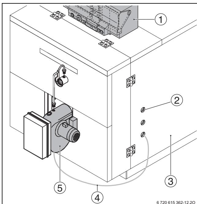
Рис 33 Монтаж кабеля горелки у котлов 120 - 1200 кВт
