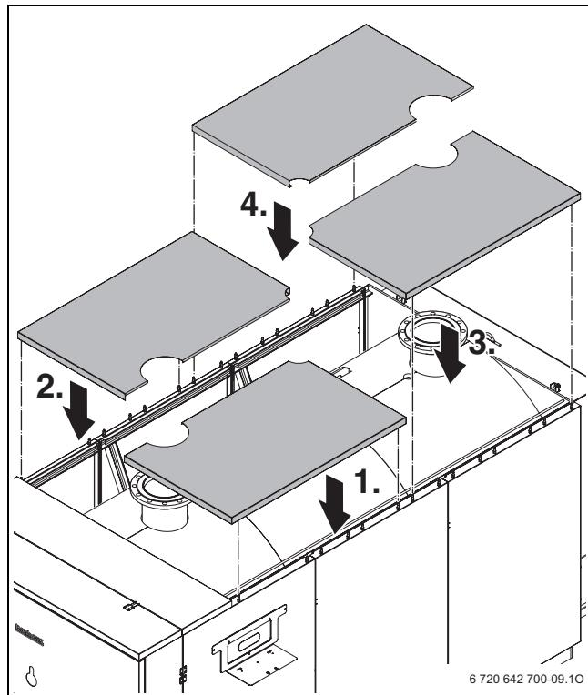
Рис 38 Монтаж боковых верхних крышек на котлах 1400 - 1850 кВт
