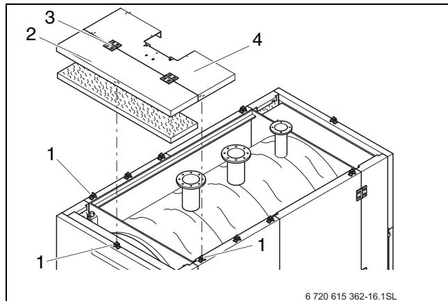
Рис 27 Установка передней крышки у котлов 120 - 1200 кВт
