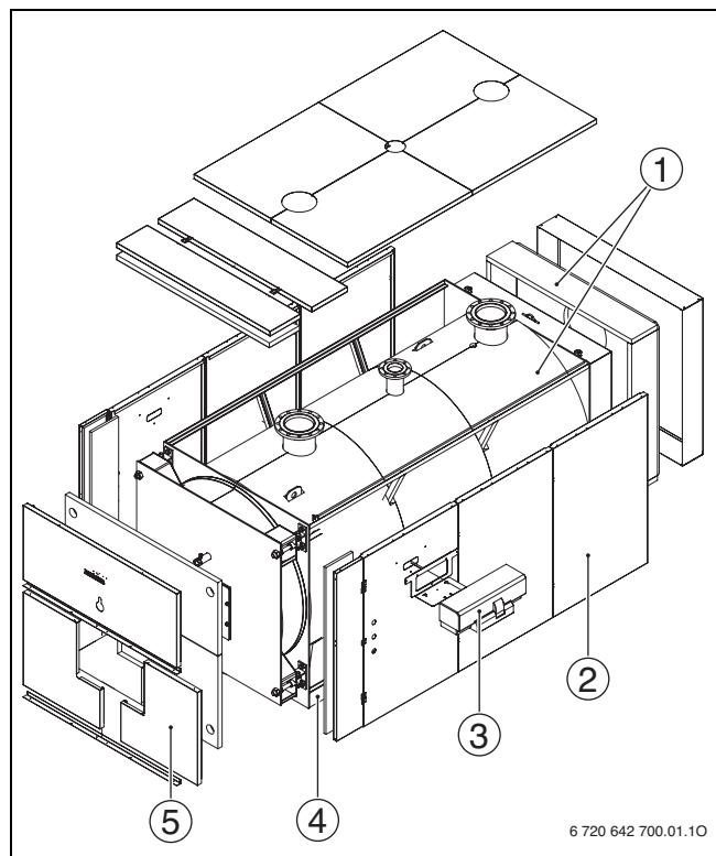
Рис 2 Специальный отопительный котёл Logano 1400-1850 кВт
