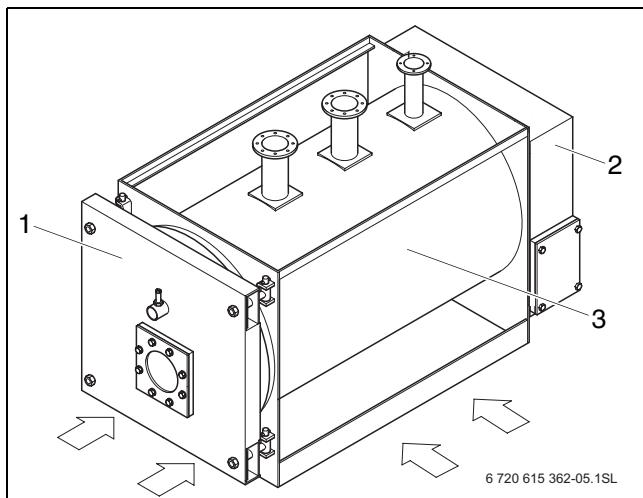
Рис 6 Транспортировка котла вилочным погрузчиком/двумя грузоподъёмными тележками
