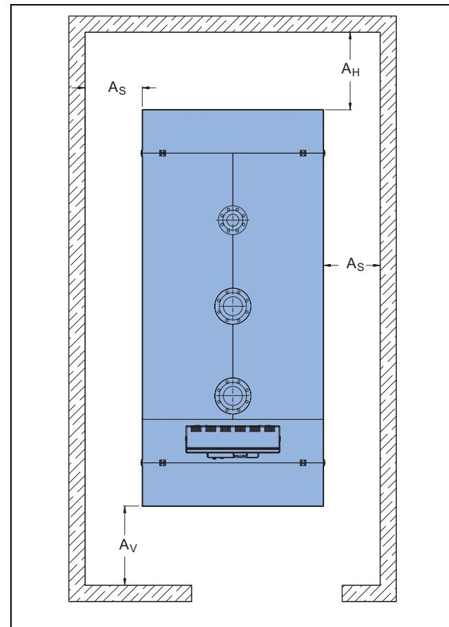
Рис 8 Помещение для установки котла (размеры в мм)
