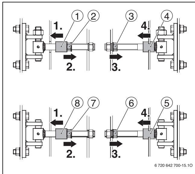
Рис 14 Переустановка дверцы горелки у котлов 1400 - 1850 кВт
