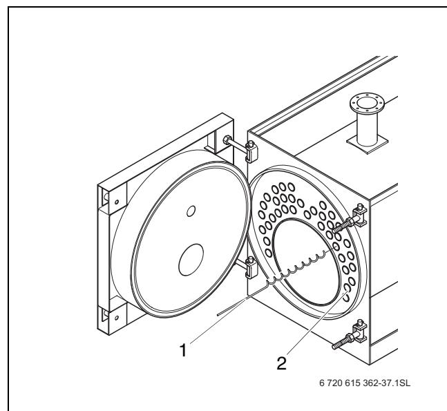
Рис 44 Корректировка предварительного напряжения турбуляторов
