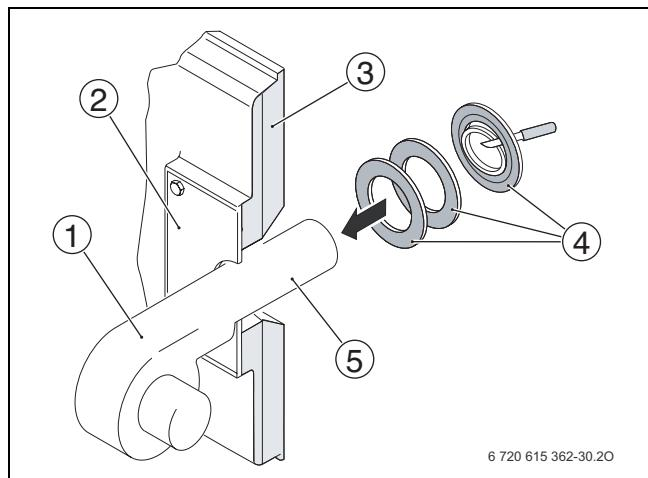
Рис 22 Монтаж горелки
