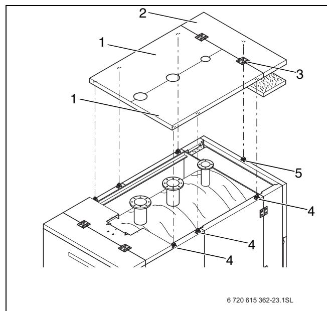
Рис 37 Монтаж крышек на котлах 120 - 1200 кВт
