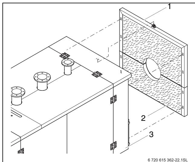
Рис 36 Монтаж задней стенки на котлах 120 - 1200 кВт
