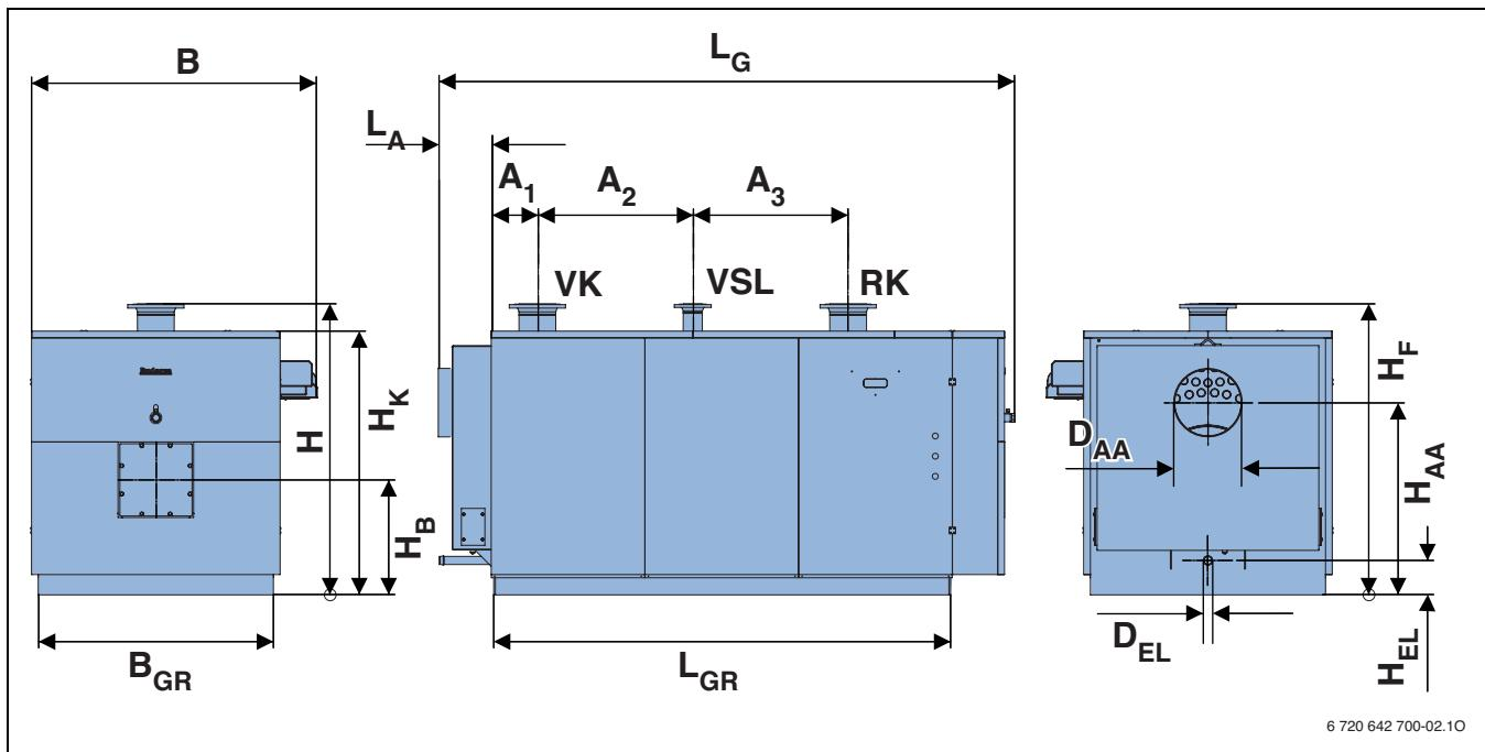
Рис 4 Размеры Logano 1400 - 1850 кВт
