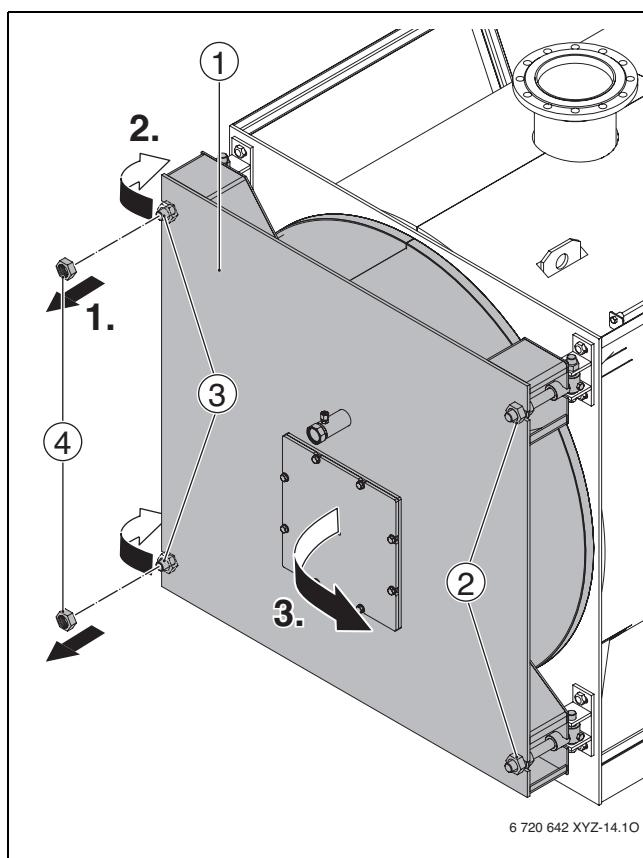
Рис 13 Открытие дверцы горелки у котлов 1400 - 1850 кВт
