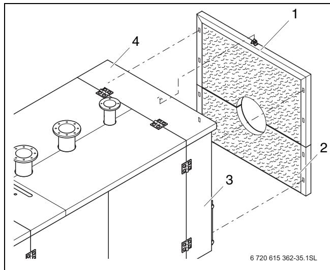
Рис 41 Демонтаж задней стенки у котлов 120 - 1200 кВт
