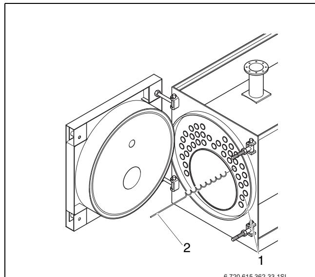
Рис 39 Удаление турбуляторов
