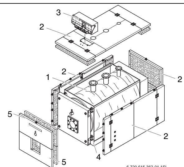
Рис 1 Специальный отопительный котёл Logano 120-1200 кВт
