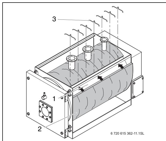
Рис 15 Установка теплоизоляции корпуса котлов 120 - 1200 кВт
