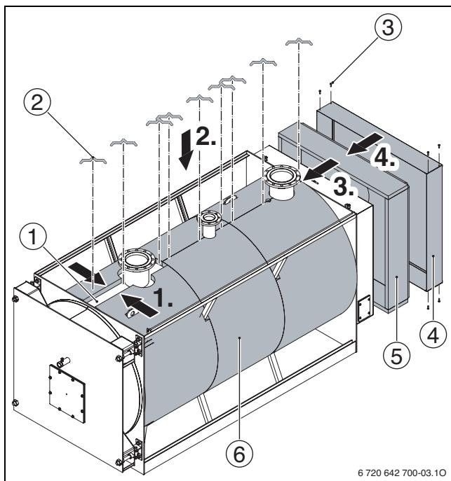
Рис 16 Установка теплоизоляции корпуса котлов 1400 - 1850 кВт
