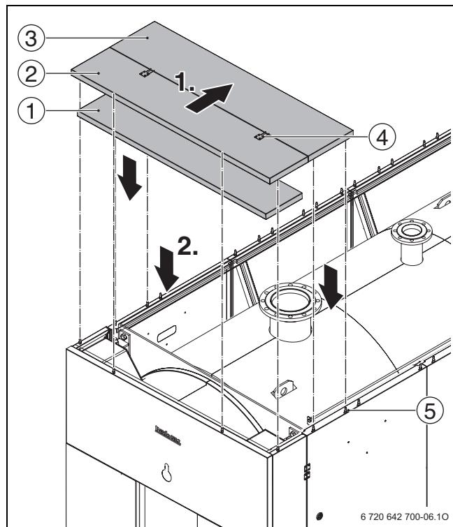
Рис 28 Установка передней крышки у котлов 1400 - 1850 кВт
