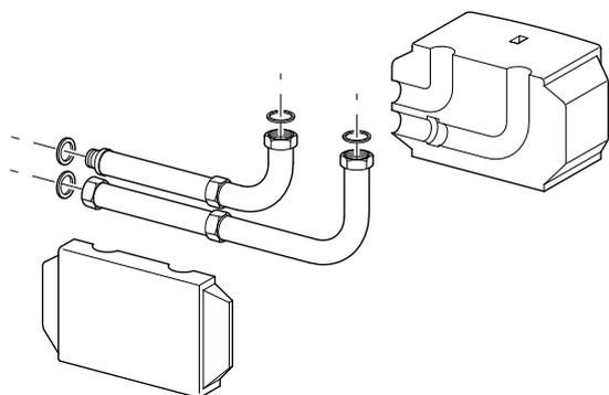
Дополнительный комплект ES2 предназначен для монтажа 2-й насосной группы с комплектом KAS2.
