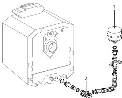
Комплект AAS предназначен для присоединения расширительного бака с вентилем для наполнения и слива.
