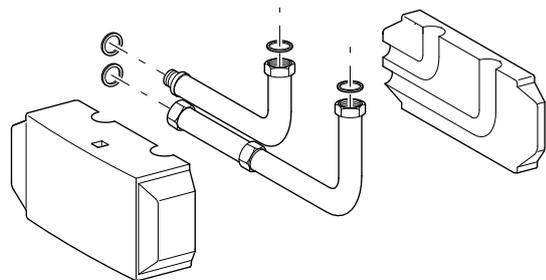
Дополнительный комплект ES3 предназначен для монтажа 3-й насосной группы с комплектом KAS2.
