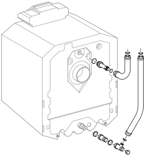
Комплект труб и соединителей для подключения котла KAS 1 обеспечивает установку насосной группы HS /HSM (→ пункт П1.1.) или распределительного коллектора НКВ (→ пункт П1.5.).
