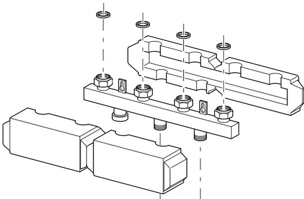
Распределительный коллектор НКВ предназначен для монтажа насосных групп HS / HSM.
