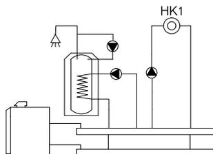
Необходимо выяснить какие отопительные системы будут использоваться. Наиболее часто используемые системы – это радиаторное и системы «теплых полов», а также их комбинация. Если планируется отопление только с использованием радиаторов, то такая **система с одним отопительным контуром (HK1)**.
