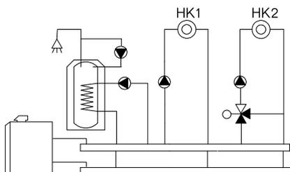
Если планируется, помимо радиаторов, использовать систему «теплых полов» и есть необходимость в том, что система управления котла должна выдавать определенный температурный режим в контур «теплых полов», то данная система имеет **два отопительных контура (HK1, HK2)**.
