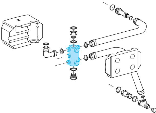
Как и комплект подключения котла KAS 1, комплект KAS 2 соединяет отопительный котел с отопительным контуром. Через многофункциональный распределительный блок, входящий в этот комплект, возможно подключение к одному, двум (→ пункт П1.7.) или трем (→ пункт П1.8.) различным отопительным контурам.
