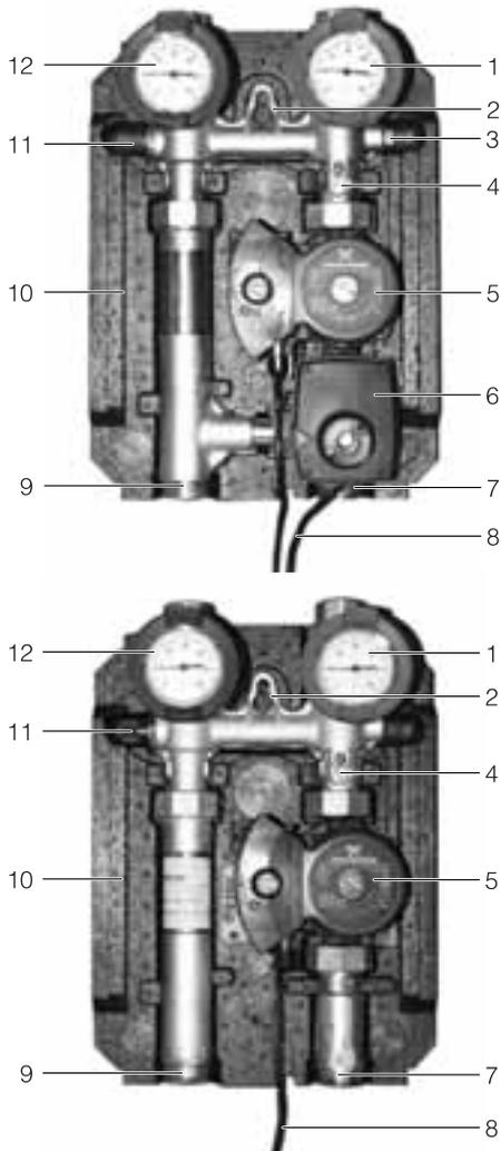
Насосные группы HS / HSM представляют собой готовые узлы для подключения отопительного контура к котлу. HS и HSM различаются отсутствием/наличием трехходового смесительного клапана с электроприводом. Существуют исполнения смесителя с присоединительными размерами DN 25 и DN 32. Группы укомплектованы циркуляционными насосами со ступенчатым (напр. HS(M) 25) и электронным регулированием (напр. HS(M)25-E).
