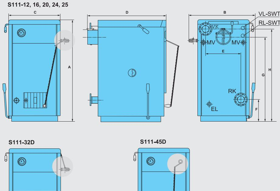
**Рис. 3 Размеры и подключения**
