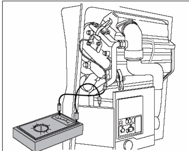
Рис. 32 Измерение тока ионизации
