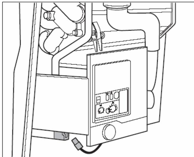
Рис. 41 Проверка схемы подключения к KIM
