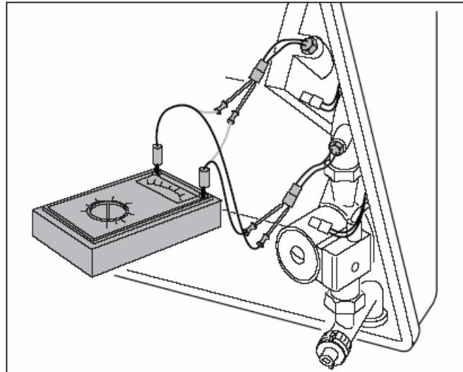
*Рис. 20 Проверка датчиков прямой/обратной воды*
