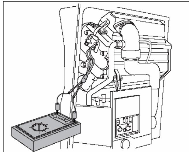
Рис. 30 Проверка калильного запального электрода
