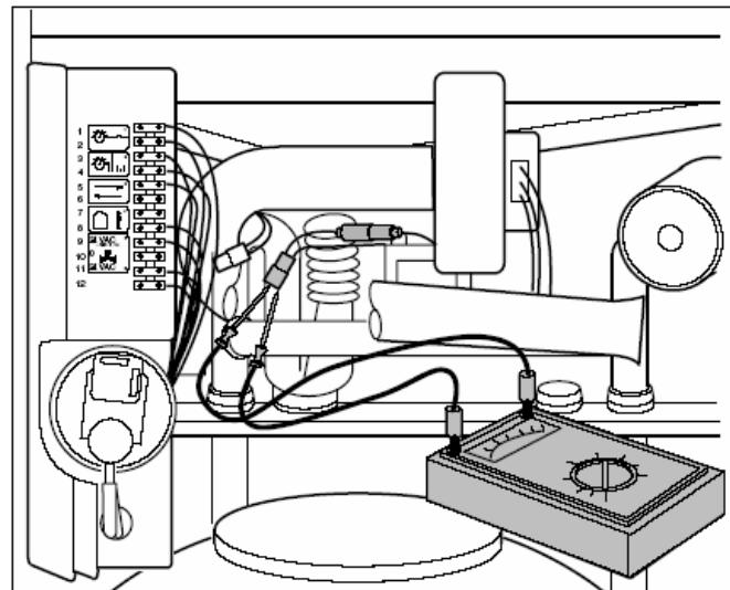
Рис. 13 Пробверка трансформатора
