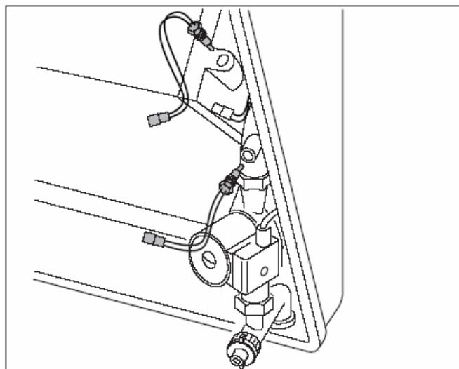
Рис. 23 Замена датчиков прямой и обратной воды
