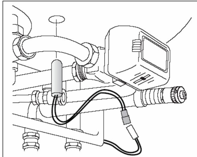
Рис. 24 Замена датчика водопроводной воды
