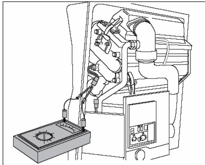
*Рис. 21 Проверка датчика защиты*
