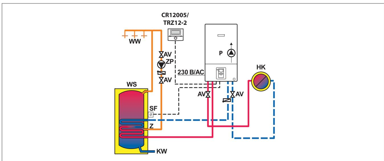
**3/2** Пример гидравлической схемы системы отопления с одноконтурным котлом Gaz 6000 W WBN – 24 HRN: один отопительный контур без смесителя, без гидравлического разделителя и с приготовлением горячей воды в баке косвенного нагрева
