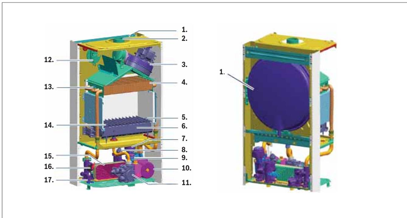
1/4 Конструкция настенного газового котла Gaz 6000 W
