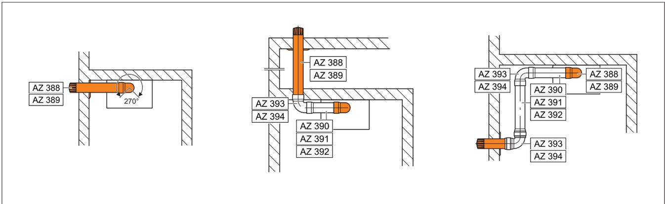
Коаксиальные трубопроводы для вертикального отвода продуктов сгорания и подачи воздуха на горение (тип C32).
