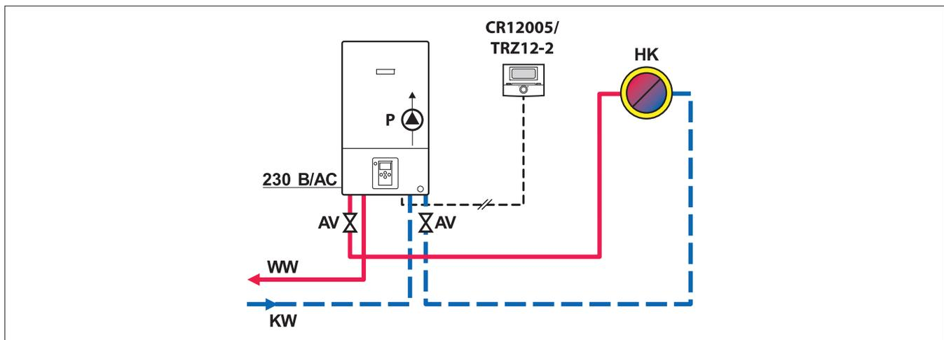
**3/1** Пример гидравлической схемы системы отопления с двухконтурными котлами Gaz 6000 W WBN-18/24 CRN: один отопительный контур без смесителя, без гидравлического разделителя и с приготовлением горячей воды проточным способом с помощью встроенного в котел пластинчатого теплообменника.
