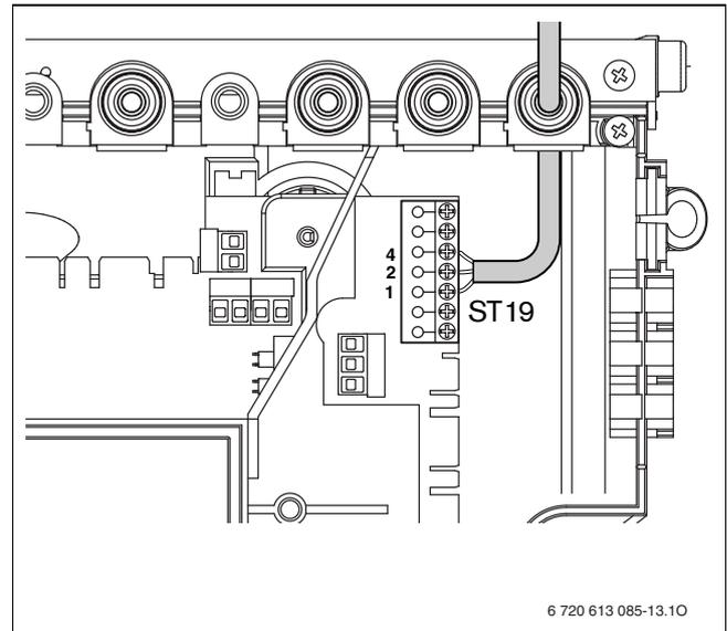
Рис 23 Подключение 24 В регулятора
