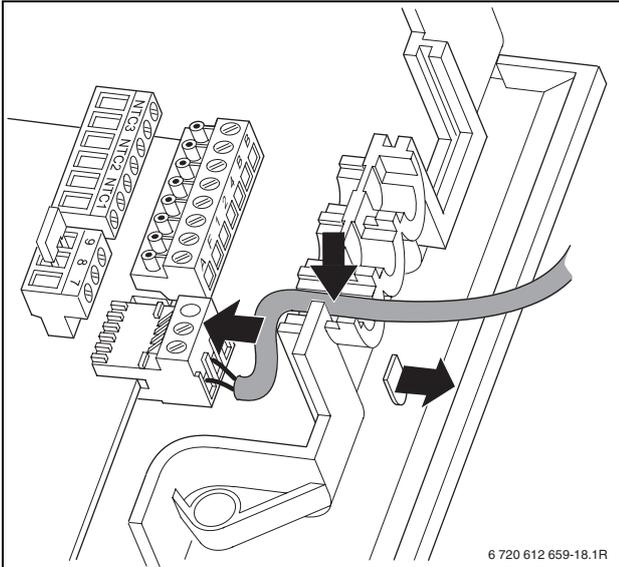
Рис 24 Разъем для подключения датчика температуры бойлера (NTC)
