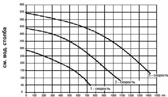
Остаточный напор для системы отопления в зависимости от расхода показан на графиках.
