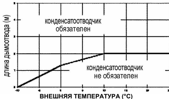
⚠ Если во время работы температура воды в котле может опускаться ниже 50°C (например, при использовании датчика уличной температуры), необходимо уменьшить максимально допустимую длину на 1 метр.
