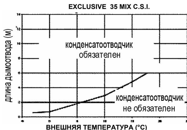
⚠ При прокладке некоторых участков дымоотвода по улице, при расчете максимально допустимой длины без конденсатоотводчика, учитывайте уличную температуру, а не температуру в месте установки котла.
