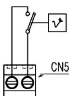
Термостат температуры в помещении (24В) подключается, как показано на схеме. Сначала необходимо снять перемычку на клеммной колодке с 2 контактами (CN5).
