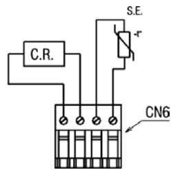
Низковольтные потребители подключаются так, как показано на схеме, к разъёму CN6.
