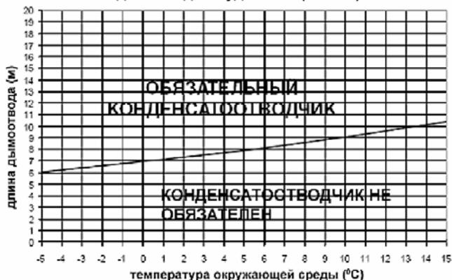
Коаксиальная система Ø80/125 мм
