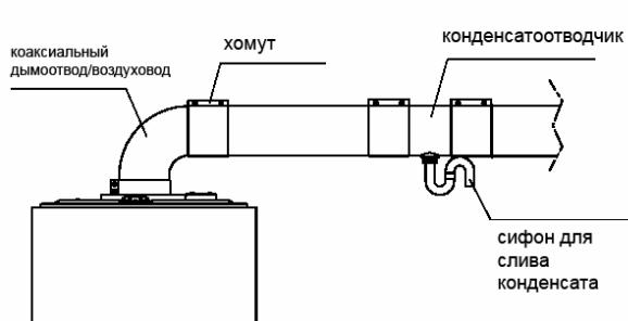
⚠ В случае работы при температуре воды на выходе из котла ниже 50°C (например, при использовании датчика наружной температуры) требуется обязательная установка конденсатоотводчика.
