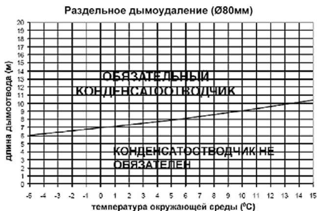
Раздельные дымоотвод и воздуховод
