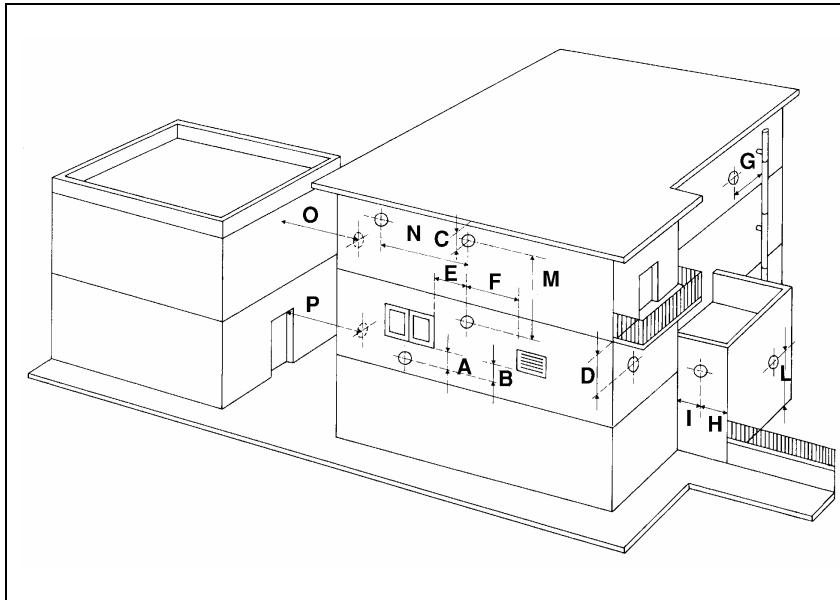
В пространство, ограниченное с четырех сторон, но открытое сверху (вентиляционные шахты, колодцы, внутренние дворики и т.п.) допускается напрямую выводить продукты сгорания газовых отопительных приборов с естественной или принудительной тягой и мощностью от 4 до 35 кВт при обязательном соблюдении следующих условий:
