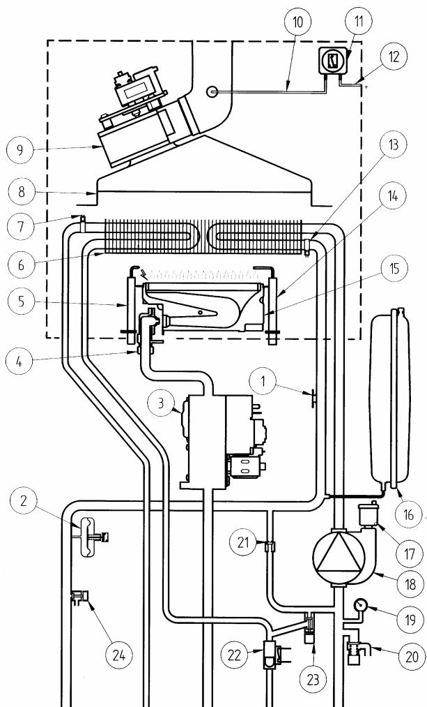
вход воды в систему отопления      выход ГВС      подача газа      вход холодной воды      возврат воды из системы отопления
