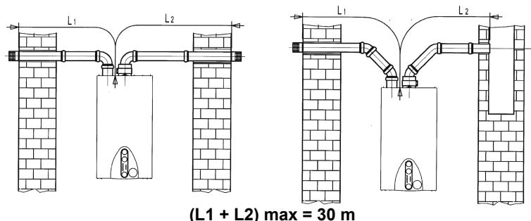
Примечание: оба наконечника (забора воздуха и отвода продуктов сгорания) могут быть установлены на одной и той же стороне здания.
