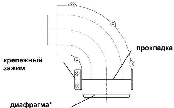
\* Если длина дымоотводящей трубы превышает 1 м, диафрагму следует удалить.
