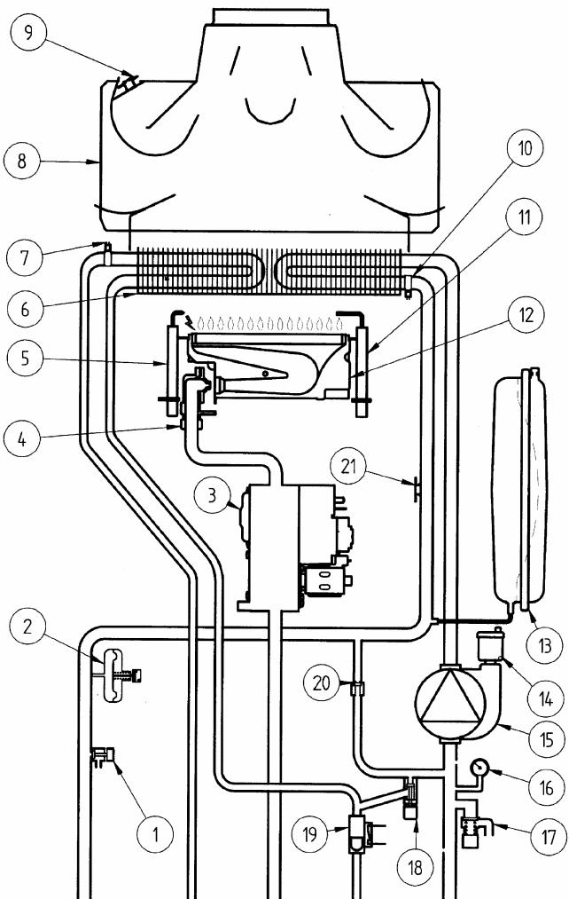
вход воды в систему отопления      выход ГВС      подача газа      вход холодной воды      возврат воды из системы отопления
