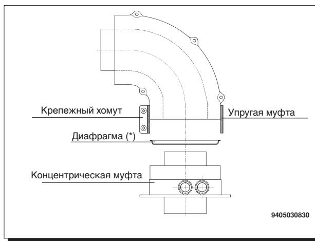
Примеры монтажа горизонтального трубопровода
