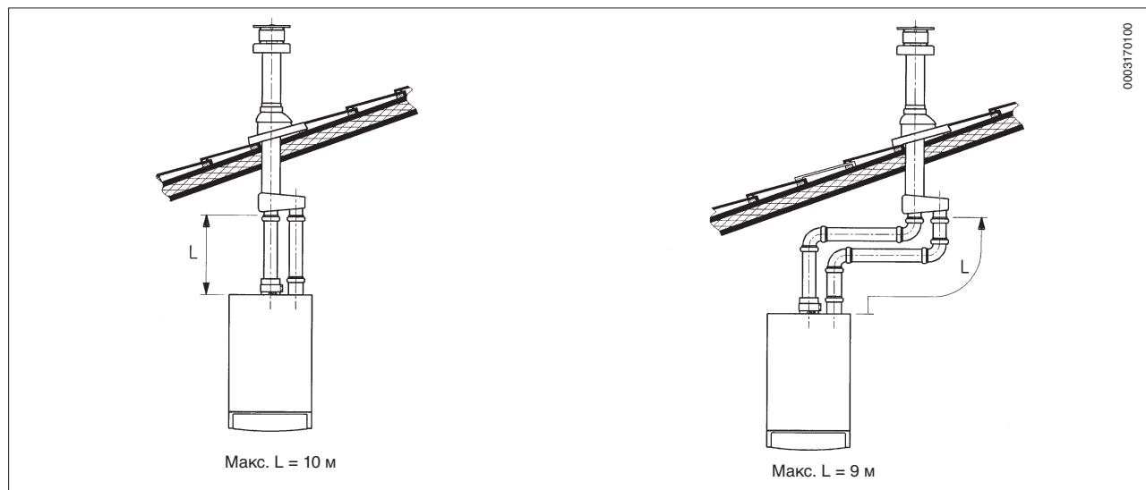
**Важно** - Выпускной трубопровод отработавших газов должен быть изолирован подходящим материалом (например, стекловатным матом) в местах его соприкосновения со стенами жилых помещений.
