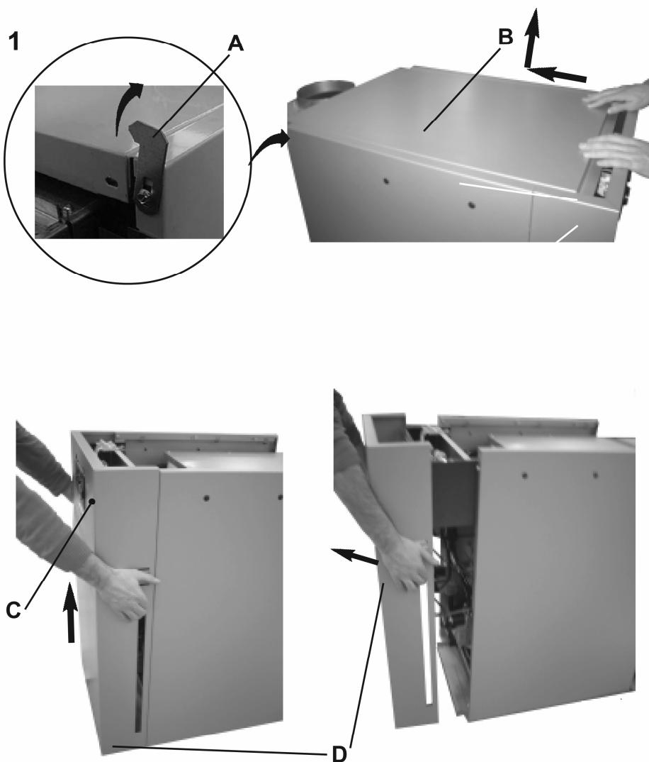
**2 А** Ослабьте винты M5 на держателе, не снимая их, приподнимите и потяните панель на себя. При необходимости отсоедините разъемы, снимите кабель питания, вытащите датчики из их корпусов (см. главу 4 на стр. 11).
