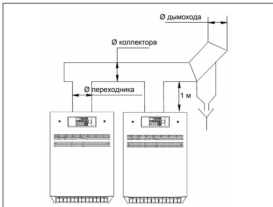
**Таблица: Расчет дымоходов при подключении двух одинаковых котлов**
