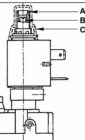
A Винт регулировки номинального давления
