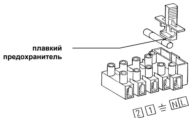
Рис.17: Клеммная колодка электропитания
