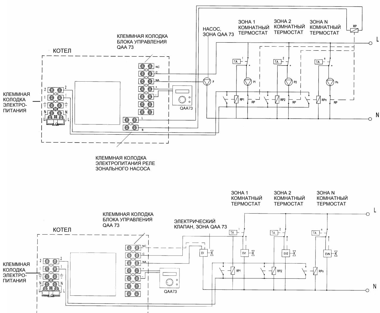
Рис. 4: Электрические схемы присоединения зональных комнатных термостатов и подачи питания на насосы и клапана
