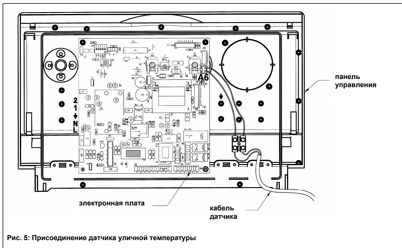
Рис. 5: Присоединение датчика уличной температуры
