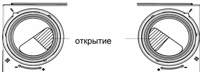
**ПОЛОЖЕНИЕ I** (L<sub>1</sub>+L<sub>2</sub>)<sub>max</sub> = 8 м
