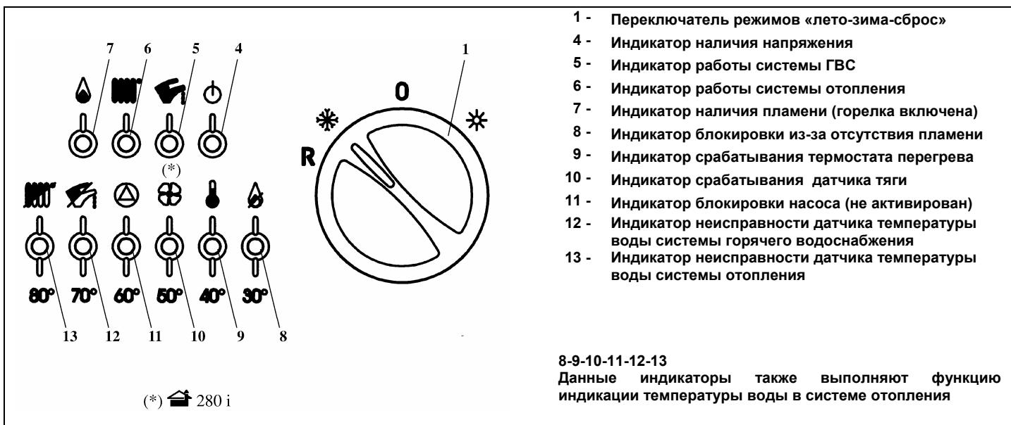
«Немигающие» индикаторы 8-13 отражают температуру в системе отопления.
