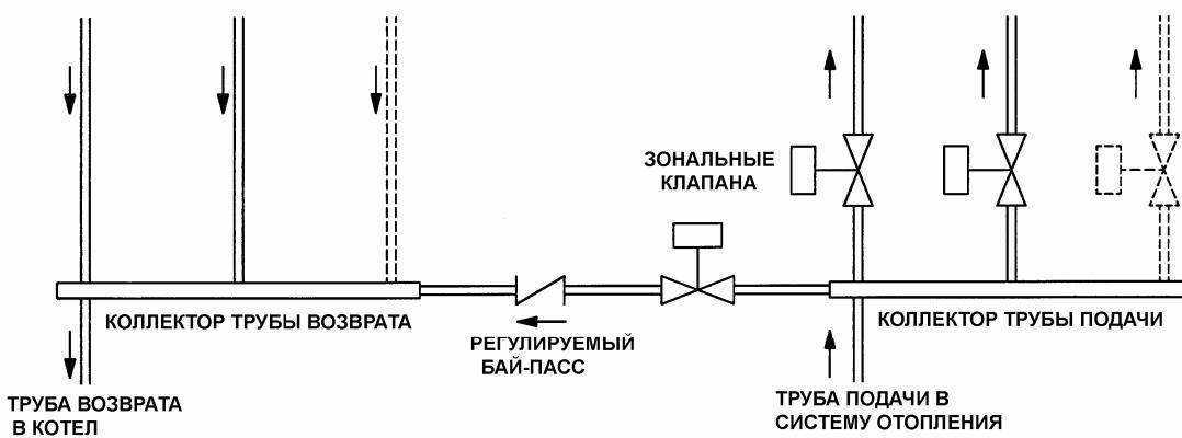
Рис. 2: Гидравлические схемы для разветвленных систем
