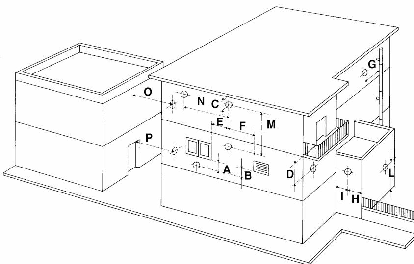
В пространство, ограниченное с четырех сторон, но открытое сверху (вентиляционные шахты, колодцы, внутренние дворики и т.п.) допускается напрямую выводить продукты сгорания газовых отопительных приборов с естественной или принудительной тягой и мощностью от 4 до 35 кВт при обязательном соблюдении следующих условий:
