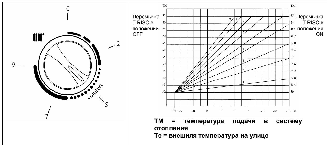
**Внимание:** Значение температуры подачи в систему отопления ТМ зависит от положения переключателя T.RISC на плате (см. § 13). Максимальное значение устанавливаемой температуры равно 85 или 45 °C (по умолчанию установлено 85°C).
