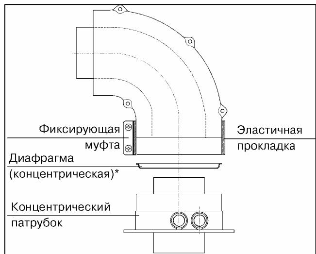
Минимальный наклон таких дымоотводящих труб в сторону улицы должен составлять 1 см на метр длины.
