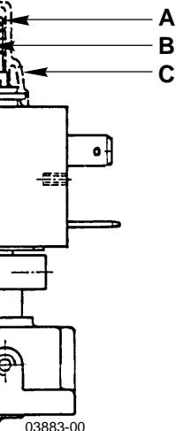
A Винт регулировки номинального давления
