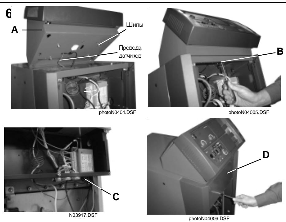
**7 A** тип LE / SE: Надеть съемные левую и правую панели на шипы и закрепить винтами M 5. Установить опорные винты. Привинтить цепочку под передней панелью корпуса пульта управления
