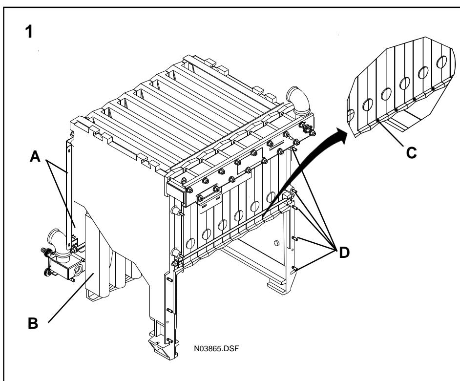
**2 А** тип LE / SE: Установить изолирующие герметизирующие ленты на котел (одну горизонтальную, одну вертикальную и одну в сгиб на угол)
