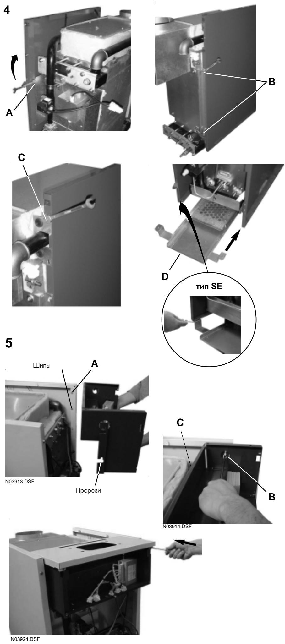
**5 А** тип LE / SE: Навинтить винты M 5 на правую и левую панель (не завинчивая до конца)
