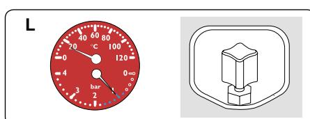
Basınç minimum değerden az ise cihazın altındaki (Detaylı görünüş resmine bakınız) su doldurma musluğunu açarak, basınç takr. 1 bar olacak şekilde kalorifer tesisatını doldurunuz. Bu işleminden sonra su doldurma musluğunu, su sızdırmayacak şekilde tam olarak kapandığını dikkat edilmelidir. Bu yüzden ortama gelebilecek hasarlardan şirketimiz sorumlu değildir.
